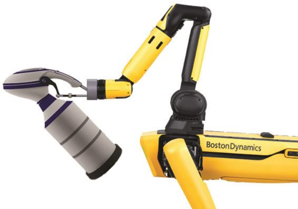
Εικόνα 3.09: SPOT ARM - Βραχίονας - Εξάρτημα σύνδεσης - Κοπτικό εργαλείο. [50], [51]
