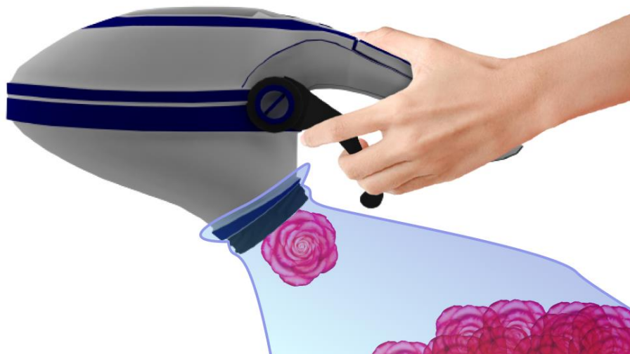
Εικόνα 2.23: Κοπτικό εργαλείο και σάκος συγκράτησης των μπουμπουκιών.
