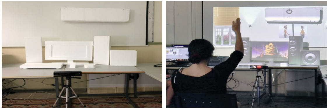
Εικόνα 4.6 - Ομοιώματα συσκευών κατασκευασμένα από αφρολέξ (αριστερά). Προβολή ψηφιακού περιεχομένου πάνω στα ομοιώματα συσκευών (δεξιά).
