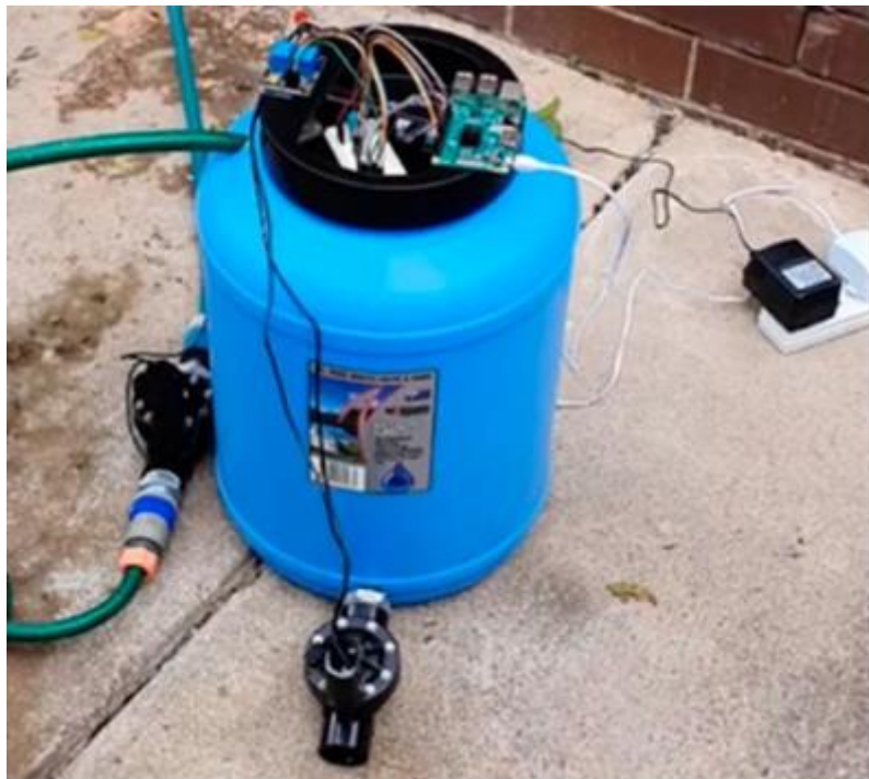
Εικόνα 26 Αρχική ανάπτυξη ασφαλούς έξυπνου συστήματος αυτοματισμού δεξαμενών νερού (Kyshwah and Rani, 2022)
