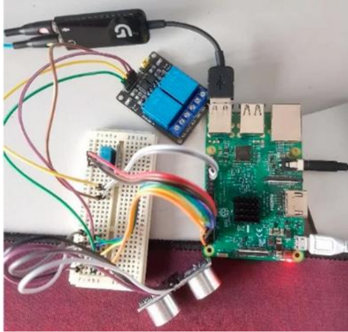
Εικόνα 25 Ενσωματωμένα χειριστήρια συσκευής με breadboard raspberry Pi (Kyshwah and Rani, 2022)
