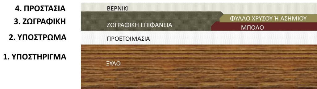
ΦΩΤΟ 1.1: σχεδιαστική αναπαράσταση των υλικών κατασκευής μιας φορητής εικόνας
