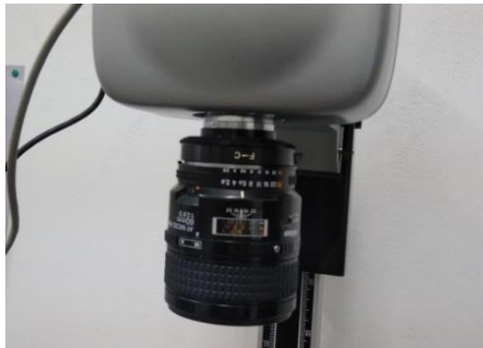
ΦΩΤΟ 2. 11: ο φακός που χρησιμοποιήθηκε σε όλες τις λήψεις. Διάφραγμα σταθερό στην ένδειξη 5,6
