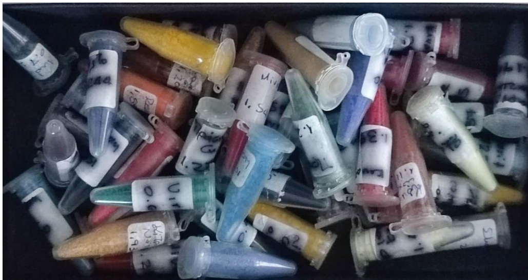
ΦΩΤΟ 2. 8: οι αμπούλες με τα χρώματα που χρησιμοποιήθηκαν για κάθε 3ml μείγματος αυγού. Σε ετικέτα αναγράφεται η ονομασία του χρώματος και η ποσότητα που περιέχεται σε gr.
