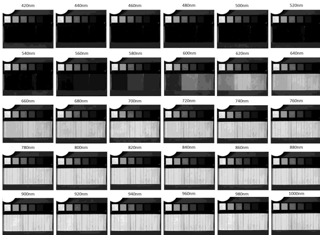
ΦΩΤΟ 2. 23: ο φασματικός κύβος. 30 λήψεις από 420-1000nm σε σειρά ανά 20 nm
