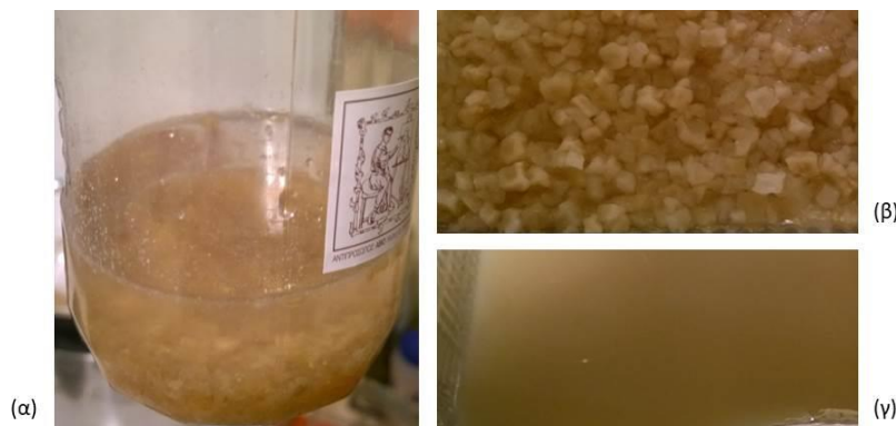
ΦΩΤΟ 2. 2: τα στάδια προετοιμασίας της κουνελόκολλας α) η αρχική κατάσταση της κόλλας μόλις μπει στο νερό, β) η κόλλα αφού έχει απορροφήσει όλο τον όγκο του νερού, γ) η μορφή της κόλλας αφού θερμανθεί σε υδατόλουτρο και ομογενοποιηθεί
