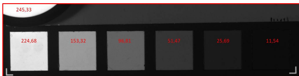
ΦΩΤΟ 2. 20: οι μετρήσεις του γκριζου σε κάθε περιοχή της διαβάθμισης της κλίμακας.
