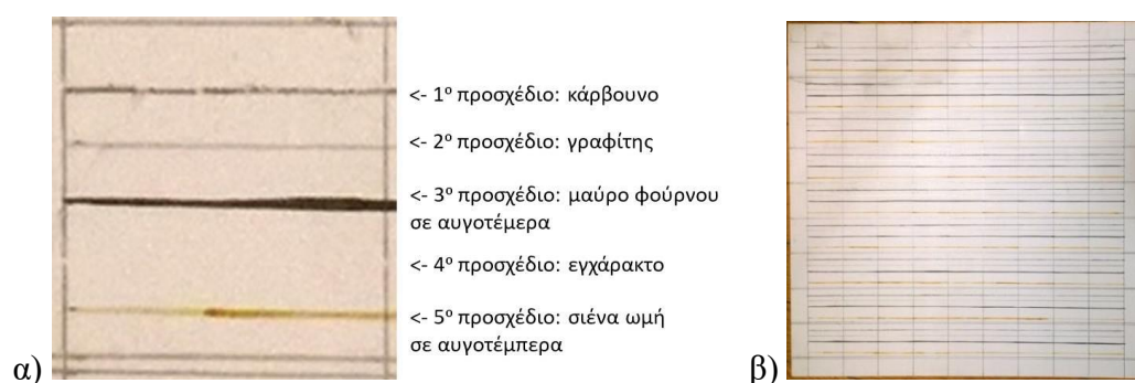
ΦΩΤΟ 2. 5: α) τα 5 προσχέδια που χρησιμοποιήθηκαν για την παρασκευή των δειγμάτων. Από πάνω προς τα κάτω φαίνονται σε σειρά το κάρβουνο, ο γραφίτης, το μαύρο Φούρνου, το εγχάρακτο και η Σιένα Ωμή β) η μορφή του εκάστοτε πάνελ με τα προσχέδια, πριν από το πέρασμα των χρωστικών
