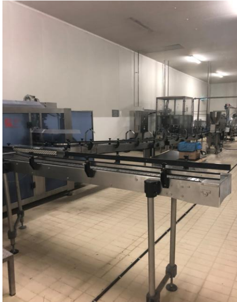
Εικόνα 11: Τοποθέτηση και πλύσιμο βάζων (εταιρεία GAEA)
