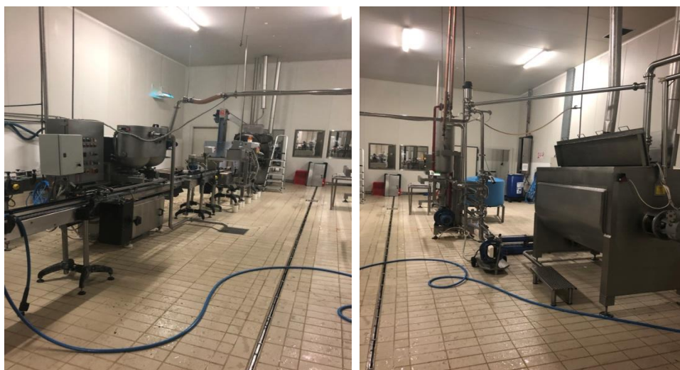
Εικόνα 14: Σωλήνας από τον οποίο περνάει το μείγμα και μεταφέρεται στο γεμιστικό μηχάνημα των βάζων (εταιρεία GAEA)
