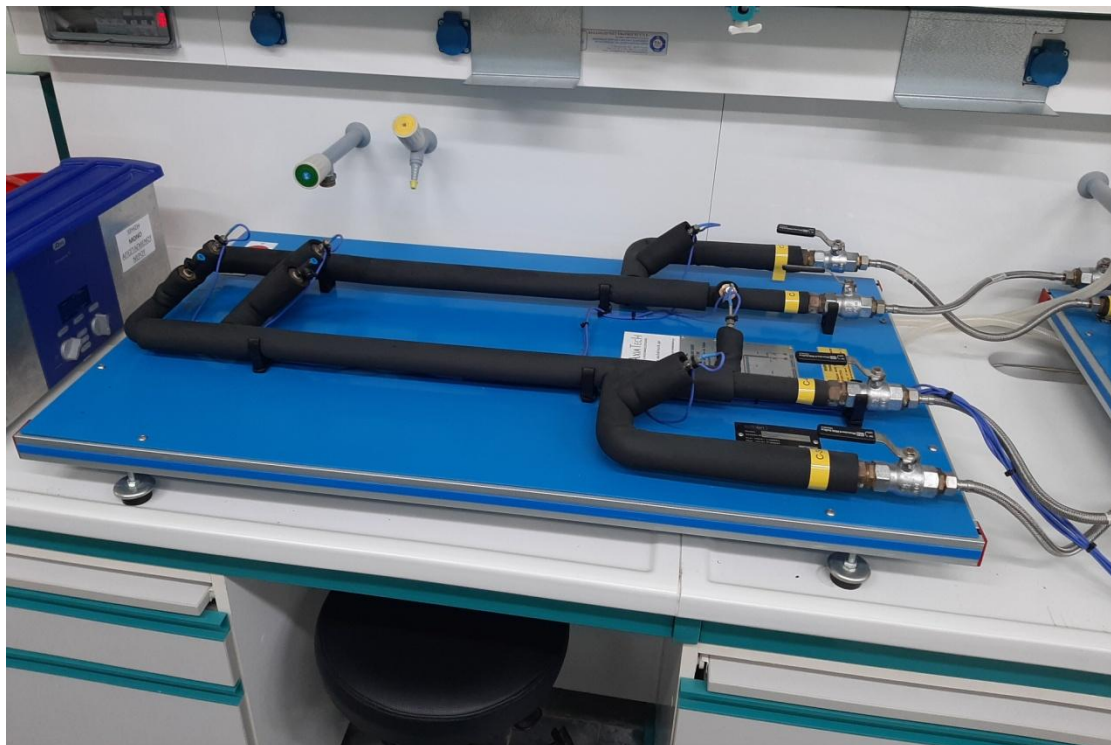
Εικόνα 32. Έναλλάκτης θερμότητας διπλού σωλήνος “TITC” (Εργαστήριο κτηρίου διοίκησης, Λήμνος).
