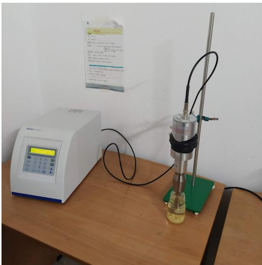
Εικόνα 14 Εκχύλιση μέσω υπερήχων
