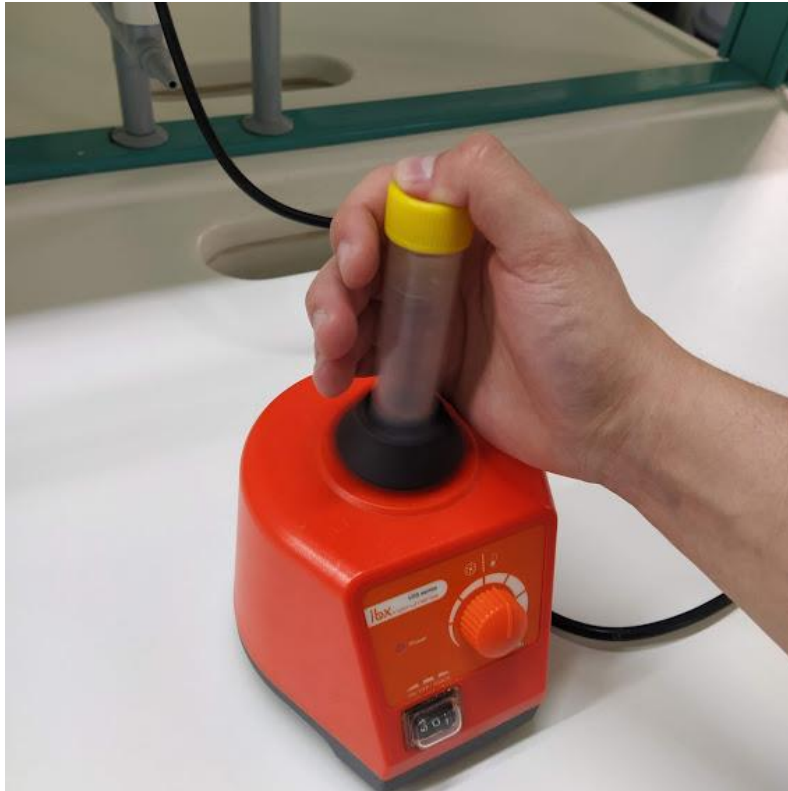
Εικόνα 41 Έντονη ανάδευση στο vortex
