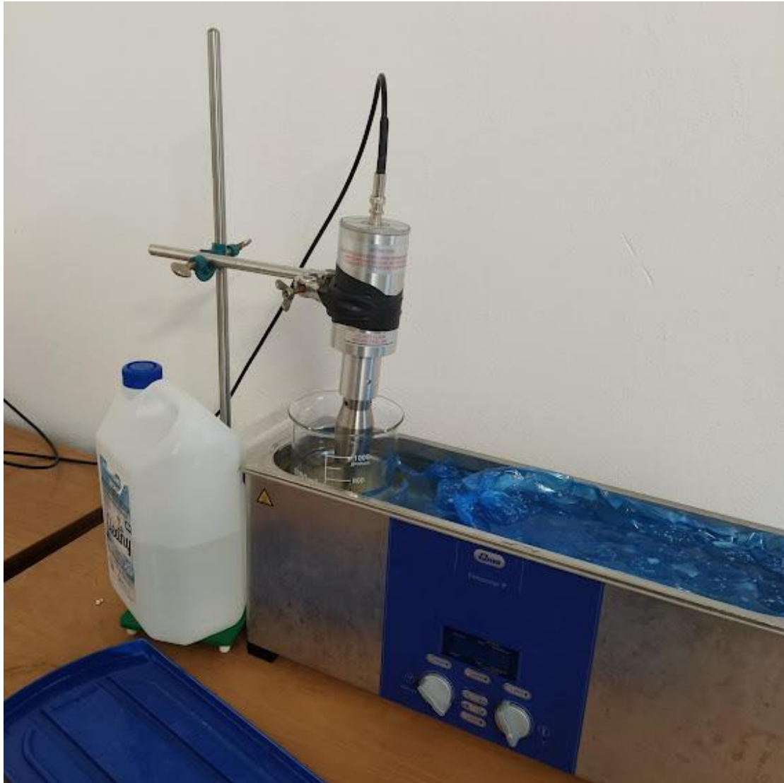
Εικόνα 22 Ψυχρή εκχύλιση με υπερήχους
