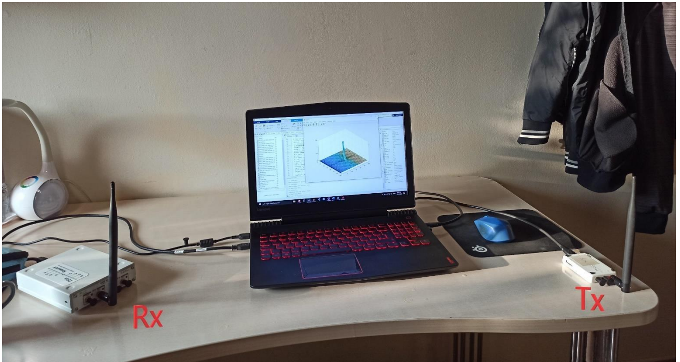
Εικόνα 14: Transmitter και Receiver για την αποστολή και λήψη ενός OTFS πιλότου.
