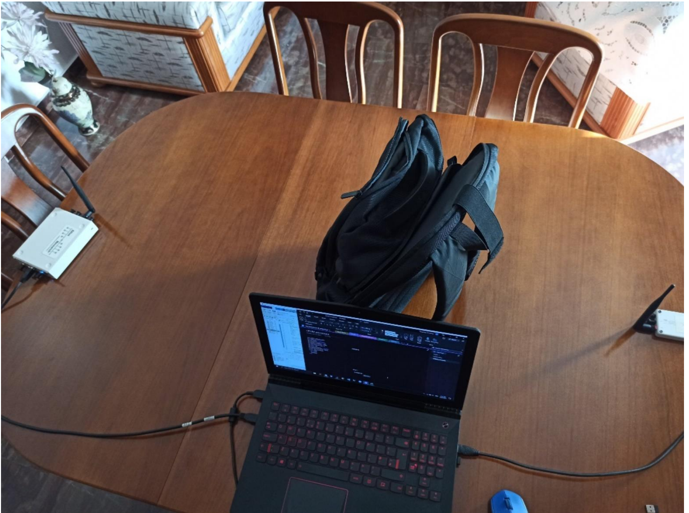
Εικόνα 3: Μετάδοση ενός συμβόλου OFDM με ένα φυσικό εμπόδιο ανάμεσα από τις κεραίες.
