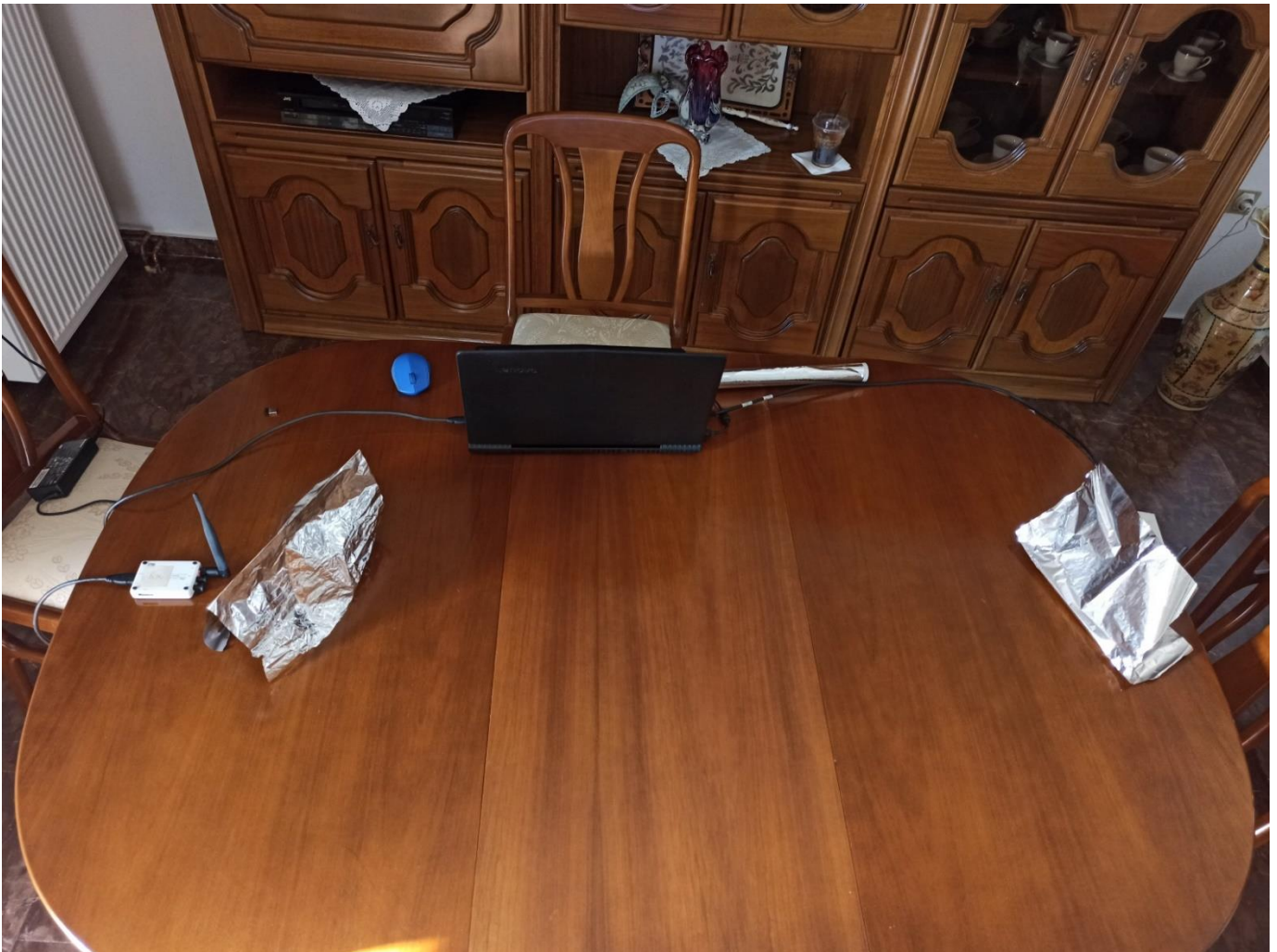
Εικόνα 4: Μετάδοση ενός συμβόλου OFDM με ένα κομμάτι αλουμινόχαρτο μπροστά από κάθε κεραία.
