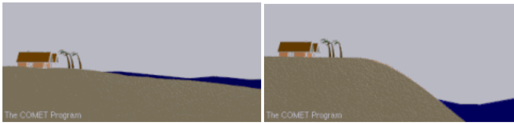
Εικόνα 8. Παράκτια περιοχή κοντά σε αβαθή πυθμένα (αριστερά εικόνα) επηρεάζεται περισσότερο από τη μετεωρολογική παλίρροια, απ ότι περιοχή δίπλα σε βαθιά θάλασσα (δεξιά εικόνα)
