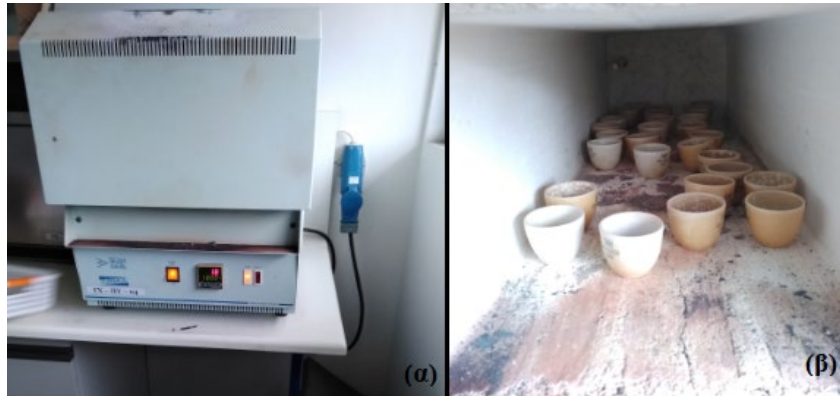
Εικόνα 2.21: (α) Το πυριαντήριο σε λειτουργία. (β) Τα υπό εξέταση δείγματα μέσα στα χωνευτήρια έπειτα από την επεξεργασία τους στο πυριαντήριο.
