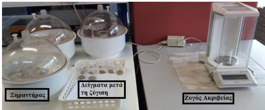
Εικόνα 2.17: Ξηραντήρας, τα δείγματα έπειτα από την ακριβή ζύγιση και ο ζυγός ακριβείας που χρησιμοποιήθηκε αντίστοιχα.
