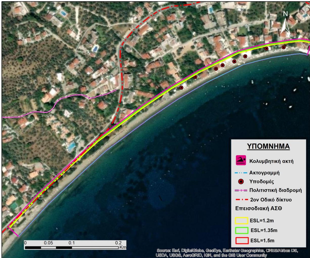
Εικ. 51: Ακτή Μεγάλη Άμμος. Η επεισοδιακή άνοδος της θαλάσσιας στάθμης θα επιφέρει σημαντικές φθορές στις υφιστάμενες υποδομές και στο τοίχιο αντιστήριξης τμήματος του 2οντος οδικού δικτύου (Υπόβαθρο: Word Imagery ArcGIS Map Service -WMS).
