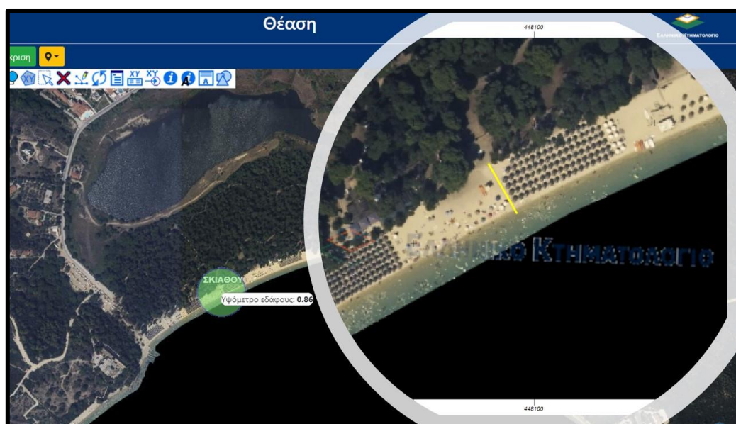
Εικ. 20: Διαδικασία εξαγωγής υψομετρικών σημείων για τη δημιουργία των υψομετρικών προφίλ των ακτών. Εδώ η γραμμική εγκάρσια τομή στην ακτή Κουκουναριές.
