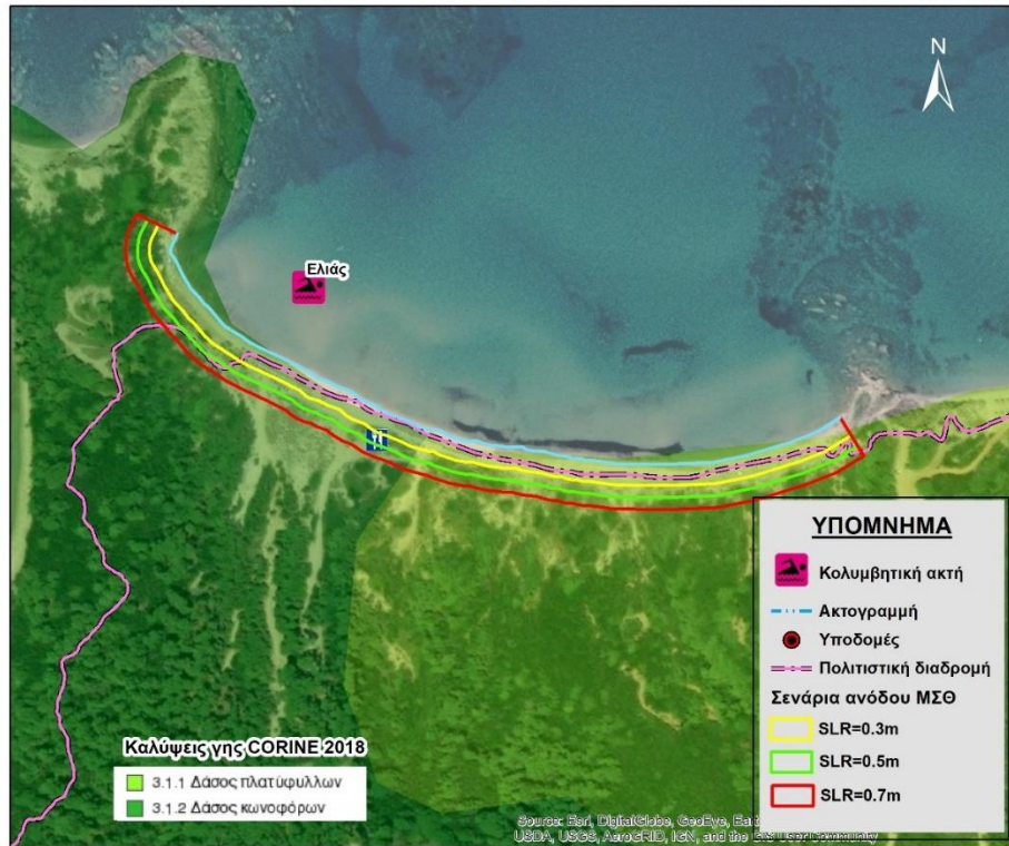
Εικ. 37: Υποχώρηση ακτογραμμής βάσει των τριών σεναρίων ανόδου ΜΣΘ και υποδομές που θα επηρεαστούν (Διατομή Ε1- ακτή Ελιάς).
