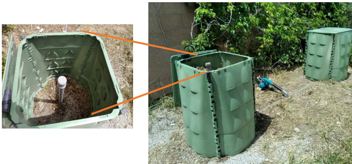
Εικόνα 13: Σύστημα ενεργητικού αερισμού με την χρήση φυσητήρα (BULLE 650W)
