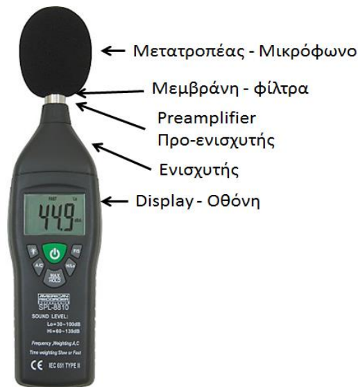
Εικόνα 6. Ηχώμετρο και τα επιμέρους τμήματά του
