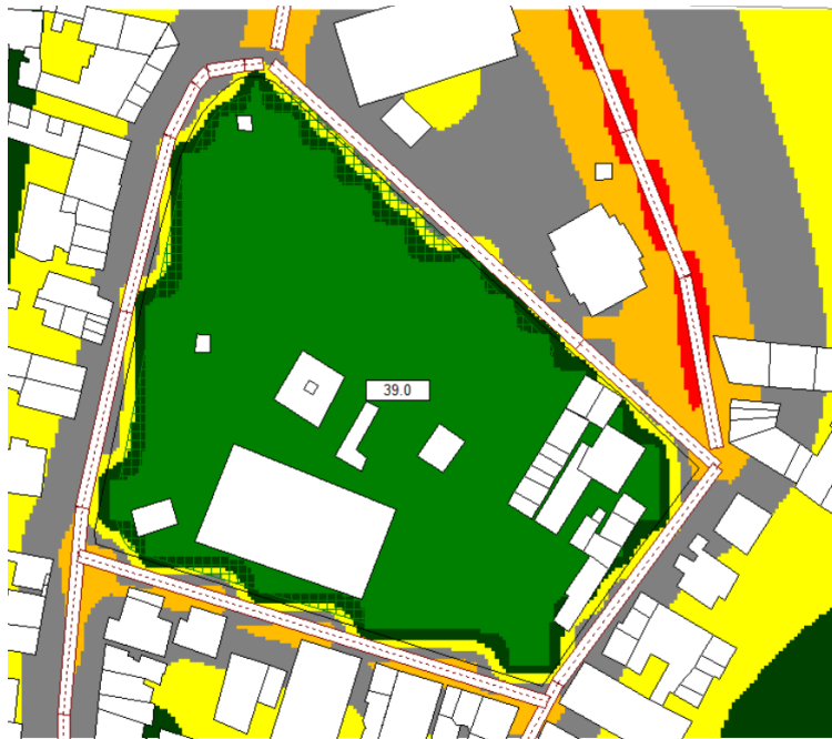
Εικόνα 35 D. Επίπεδα ηχητικής πίεσης στα 39 dB(A) με εφαρμογή ηχοπετάσματος 5 μέτρων
