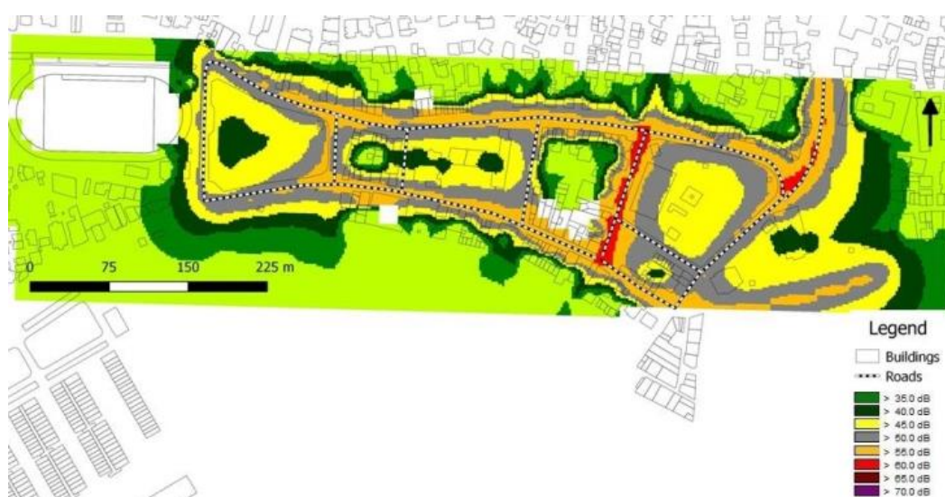
Εικόνα 36. Χάρτης θορύβου της υπό εξέταση περιοχής, χρησιμοποιώντας το λογισμικό πρόβλεψης θορύβου CadnaA
