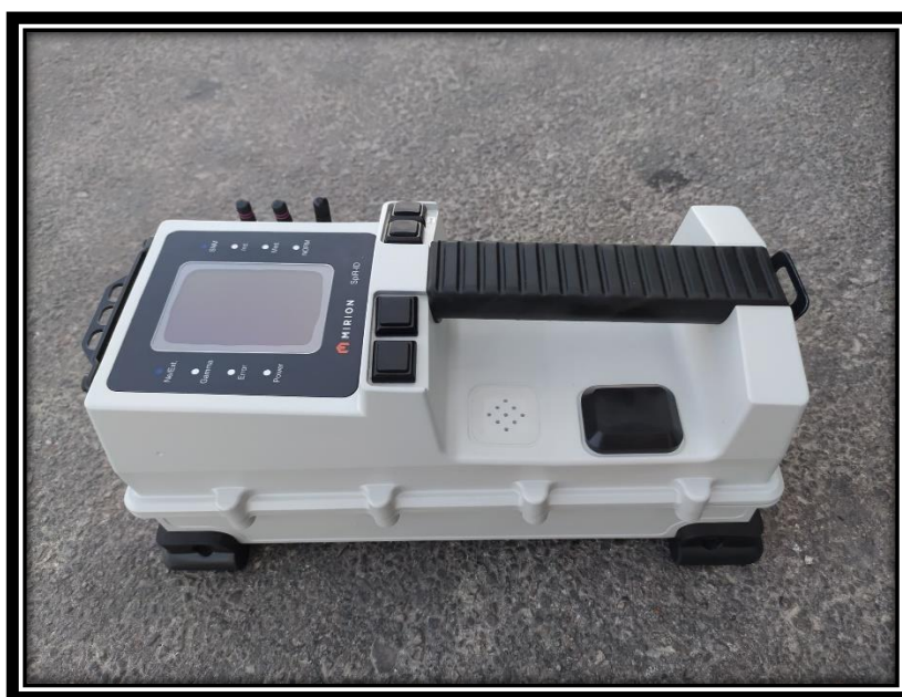
Εικόνα 7: Φορητός ανιχνευτής σπινθηρισμών NaI (Εργαστήριο Ποιότητας Υδάτων και Αέρα, Τμήμα Περιβάλλοντος, Πανεπιστήμιο Αιγαίου)
