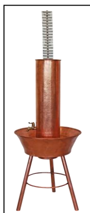
Εικόνα 6.42. Ανακατασκευή του υδραυλικού τηλέγραφου. Συλλογή και αρχείο μουσείου αρχαίας Ελληνικής τεχνολογίας Κώστα Κοτσανά
