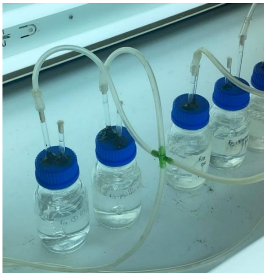
Εικόνα 3: Μπουκάλια συνδεδεμένα με τις αντλίες στον θάλαμο σταθερών συνθηκών.
