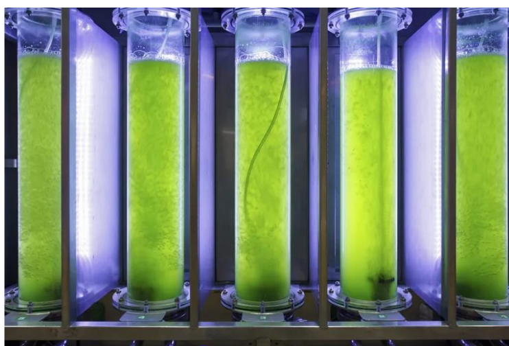
Εικόνα 2: Κλειστού τύπου καλλιέργειες μικροφυκών. Το σύστημα αποτελείται από μια σειρά κάθετα τοποθετημένων διαφανών σωλήνων. Οι σωλήνες αυτοί παρέχουν ένα ελεγχόμενο περιβάλλον για την καλλιέργεια μικροφυκών (Πηγή: Microalgae in Biofuel Production : Plantlet ).
