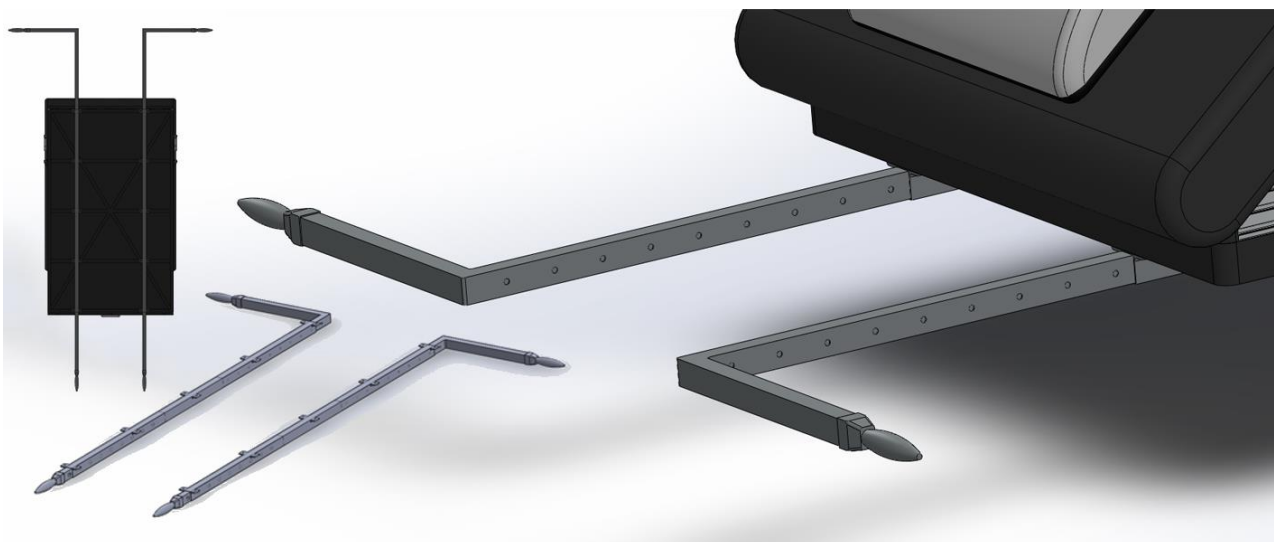
Εικόνα 42 Κοιλοδοκοί στο κάτω μέρος της βάσης
