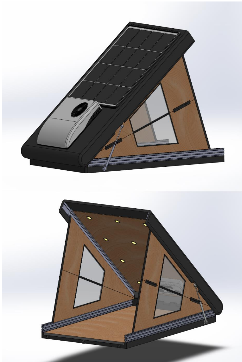
Εικόνα 49 Πλάγια τοιχώματα εφαρμοσμένα στην υπόλοιπη κατασκευή
