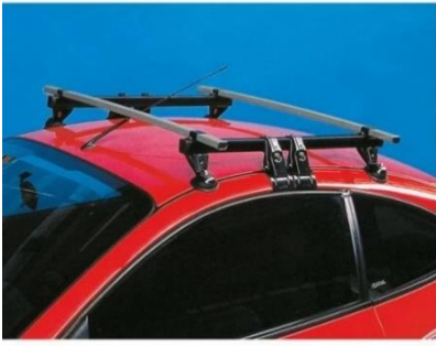
Εικόνα 32 Σχάρες και μπάρες οροφής
