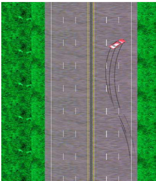
Εικόνα 16 Αποτελέσματα μανούβρας Fishhook
