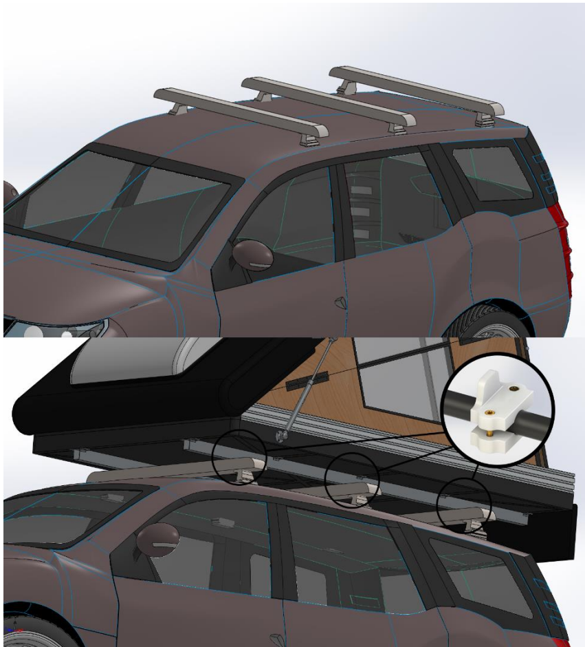
Εικόνα 59 Κοιλοδοκοί και σταυρωτή ένωση με μπάρες οροφής
