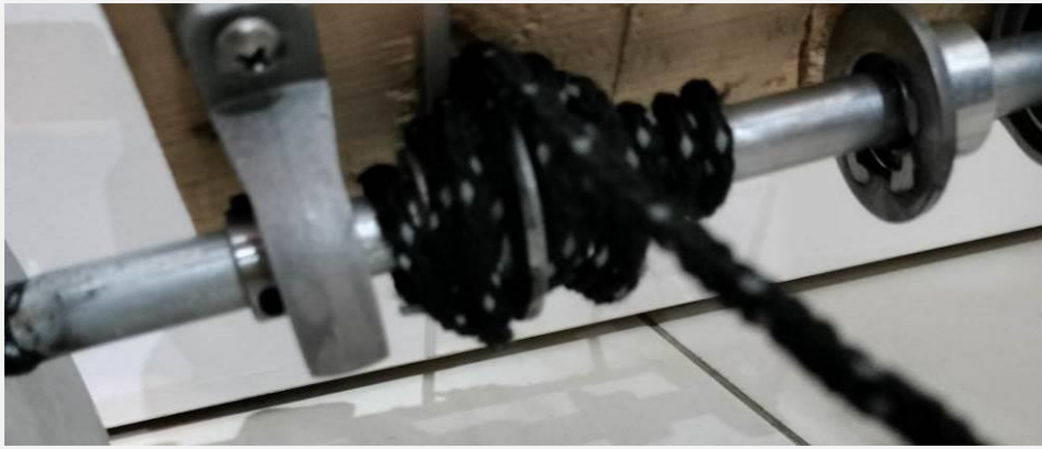
Εικόνα 28- Λάθος τύλιγμα σχοινιού
