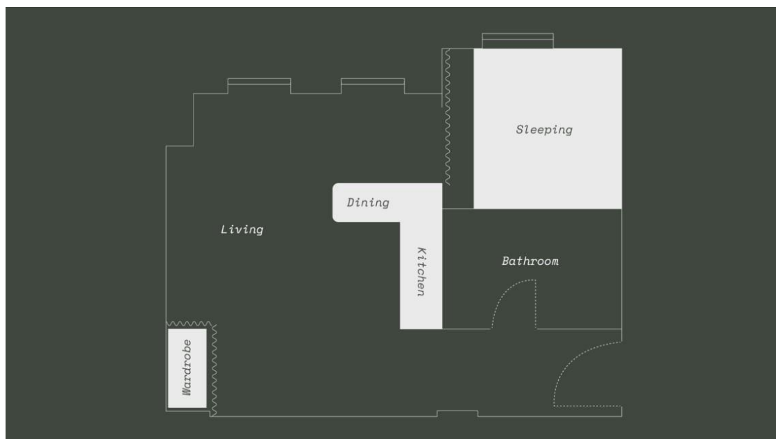
Εικόνα 2.1: Κάτωψη micro apartment 36τ.μ. με ενιαίο πολυχρηστικό χώρο, σαλόνι, κουζίνα και τραπεζαρία (Πηγή: https://www.nevertoosmall.com/ )
