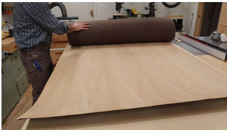
Εικόνα 3.69: Φινίρισμα μέσω λεπτής στρώσης φλαμουριάς
