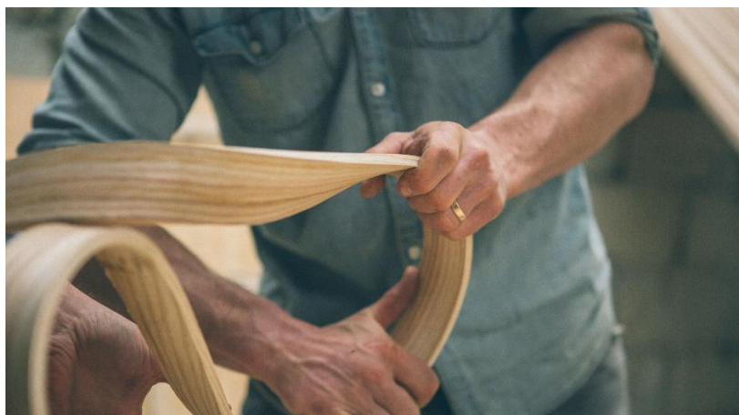
Εικόνα 3.68: τρόπος επεξεργασίας για λύγισμα ξύλου
