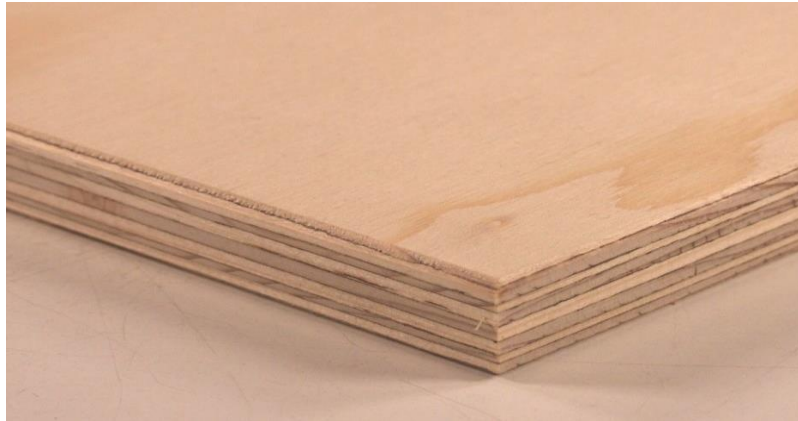
Εικόνα 2.101: Γίνονται διακριτές οι στρώσεις διαφορετικών ξύλων στο κόντρα πλακέ
