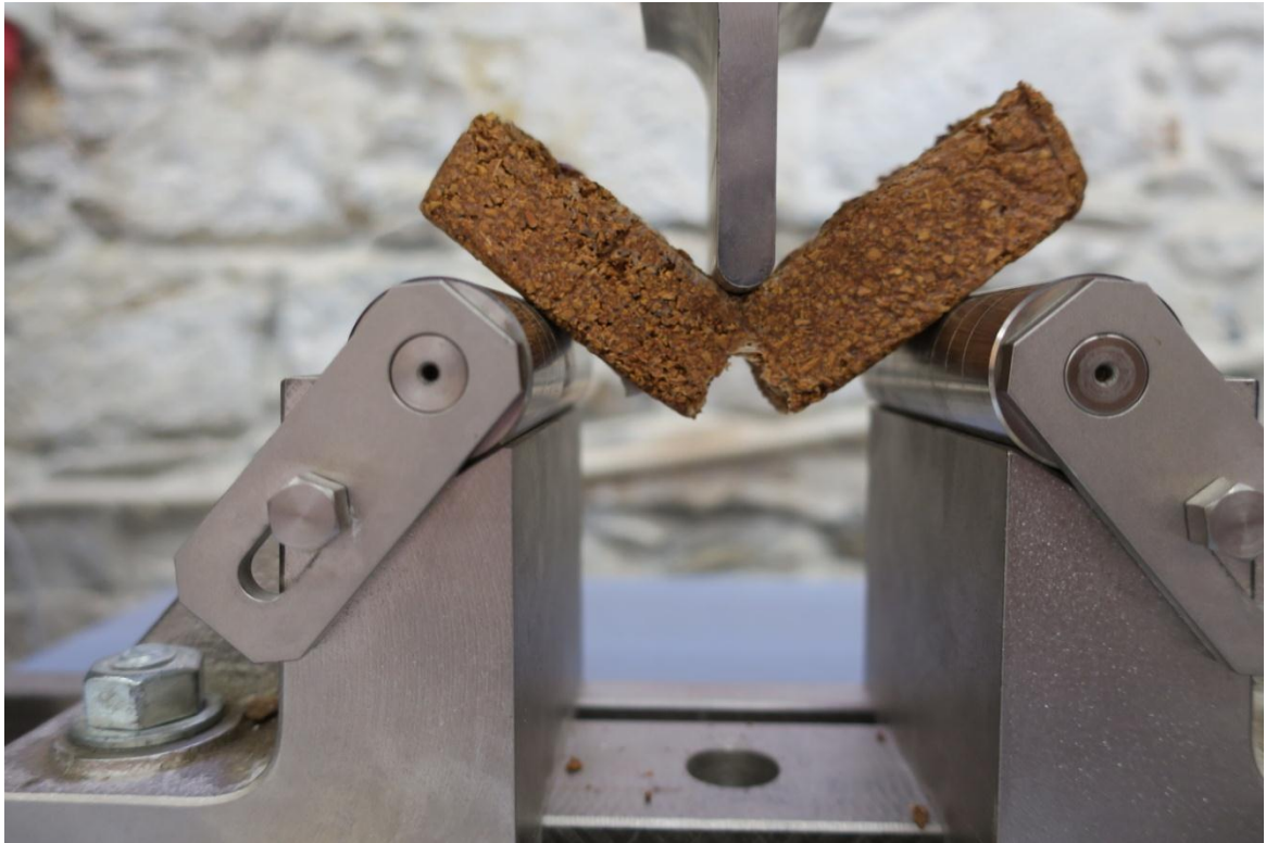
Εικόνα A 9 δοκιμή κάμψης σε δοκίμιο λ-PVAC
