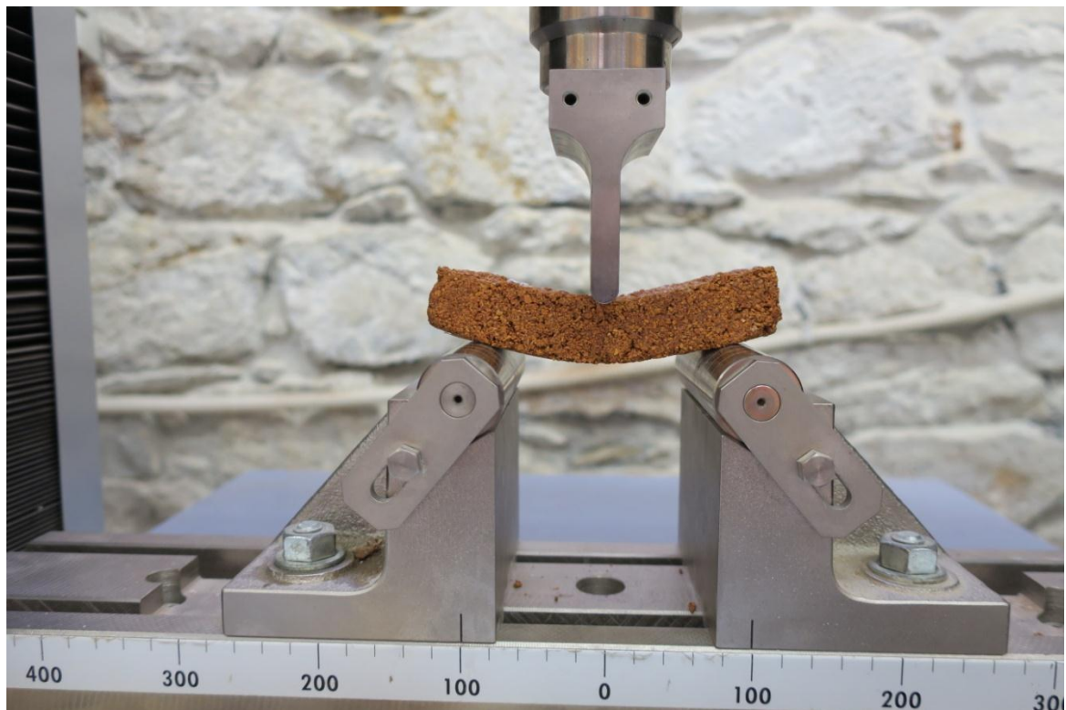
Εικόνα Α 6 δοκιμή κάμψης σε δοκίμιο λ-PVAC
