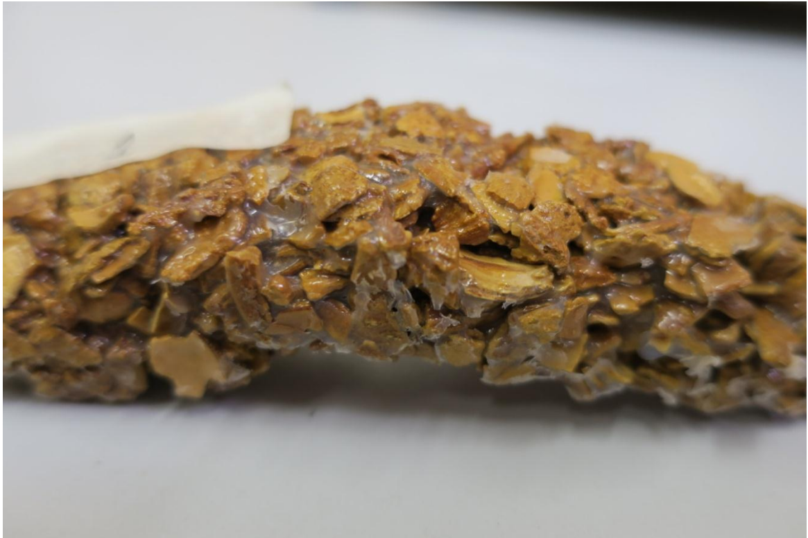
Εικόνα Α 5 δοκίμιο χ-PVAC μερικά λεπτά μετά την αφαίρεση του φορτίου
