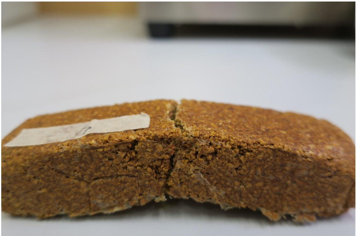
Εικόνα A 10 δοκίμιο λ-PVAC μερικά λεπτά μετά την αφαίρεση του φορτίου
