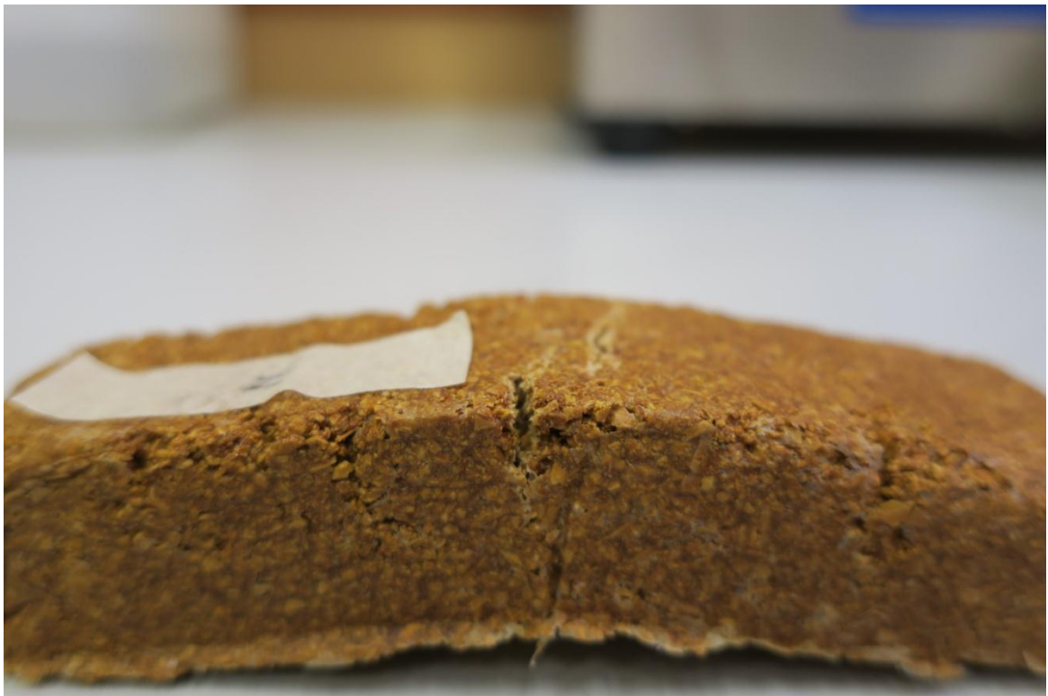
Εικόνα A 11 λεπτομέρεια από λεπτόκοκκο δοκίμιο λ-PVAC με επιφανειακή ρωγμή
