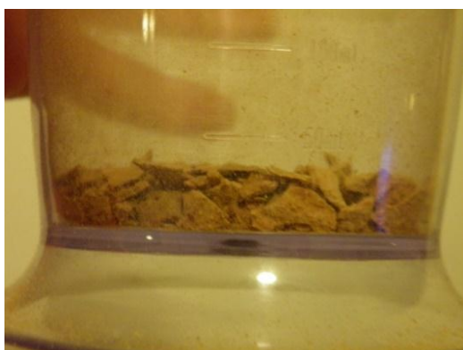
Εικόνα 16(α+β) Ογκομέτρηση συγκρατούμενου και διερχόμενου κοσκινισμένου υλικού
