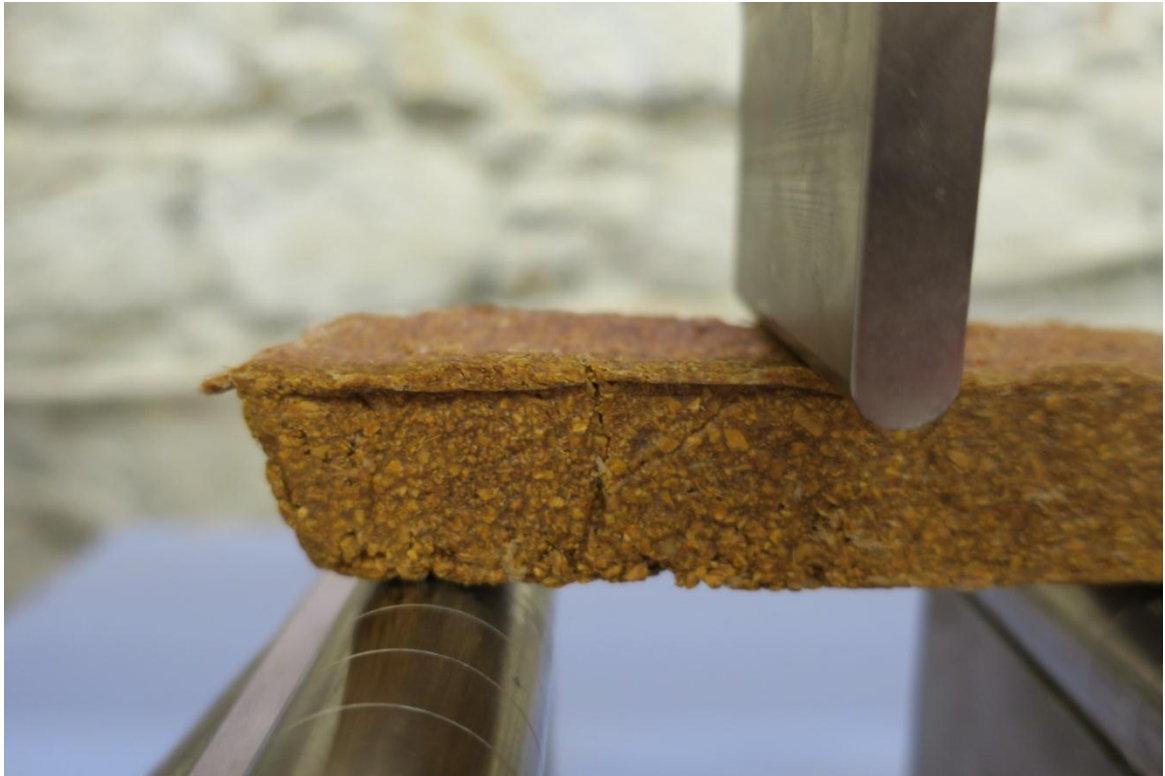
Εικόνα A 11 λεπτομέρεια από λεπτόκοκκο δοκίμιο λ-PVAC με επιφανειακή ρωγμή
