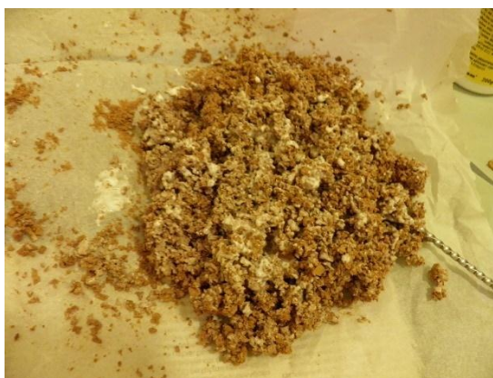
Εικόνα 21(α+β) Ανάμειξη συστατικών και διαμόρφωση δοκιμίου με PVAC
