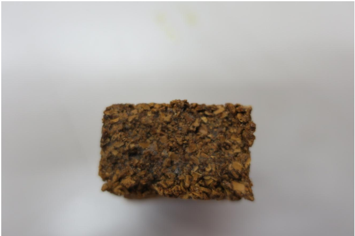
Εικόνα Α 2 επιφάνεια θραύσης του δοκιμίου λ-ψκ
