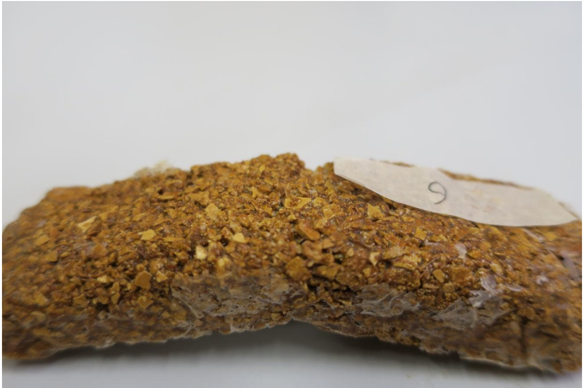
Εικόνα A 13 δοκίμιο μ-PVAC μερικά λεπτά μετά την αφαίρεση του φορτίου
