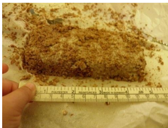
Εικόνα 21(α+β) Ανάμειξη συστατικών και διαμόρφωση δοκιμίου με PVAC
