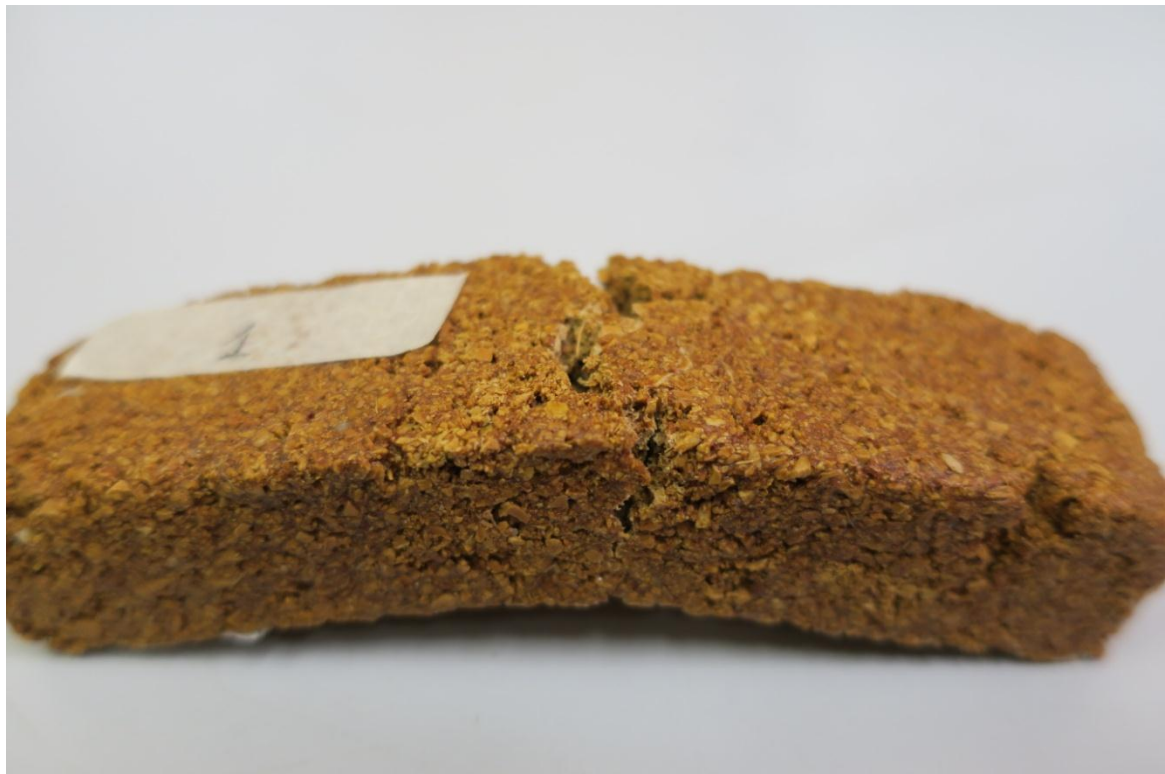
Εικόνα Α 8 δοκίμιο λ-PVAC μερικά λεπτά μετά την αφαίρεση του φορτίου
