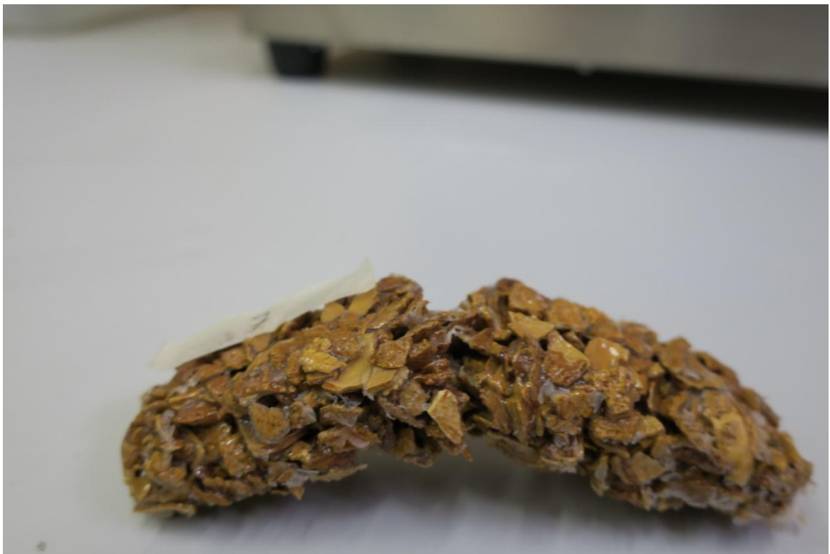
Εικόνα Α 4 δοκίμιο χ-PVAC μετά την αφαίρεση του φορτίου
