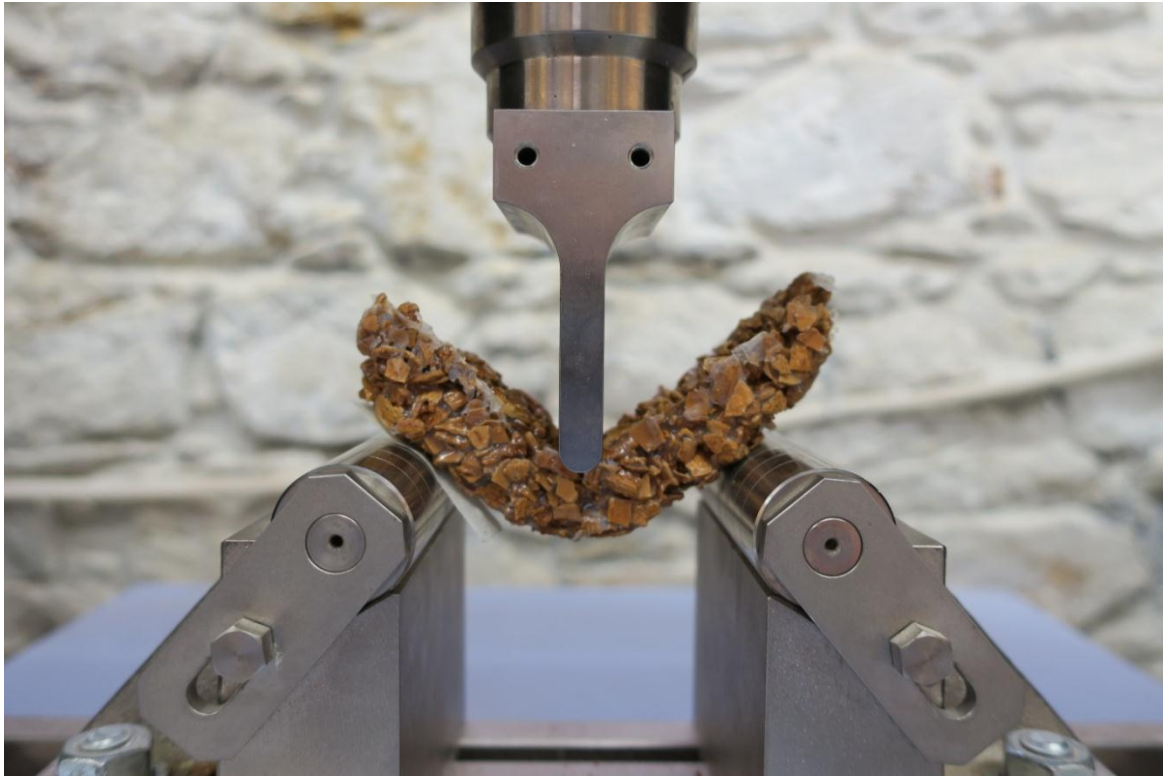
Εικόνα Α 3 δοκιμή κάμψης στο δοκίμιο χ-PVAC
