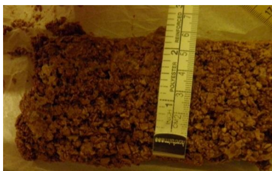
Εικόνα 23(α+β+γ) Ανάμειξη συστατικών και διαμόρφωση δοκίμιου με ψαρόκολλα
