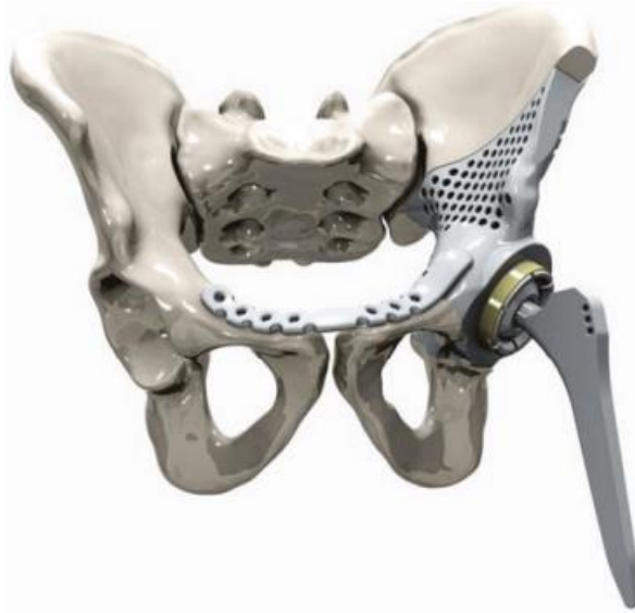
Εικόνα 14 Μοντέλο CAD ενός εμφυτεύματος ισχίου τιτανίου, κατασκευασμένο με τη χρήση SLM
