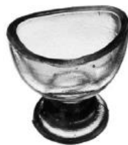
Εικόνα 12 Το πρώτο αντικείμενο που δημιούργησε ο C. Hull με τη χρήση της τεχνολογίας προσθετικής κατασκευής
