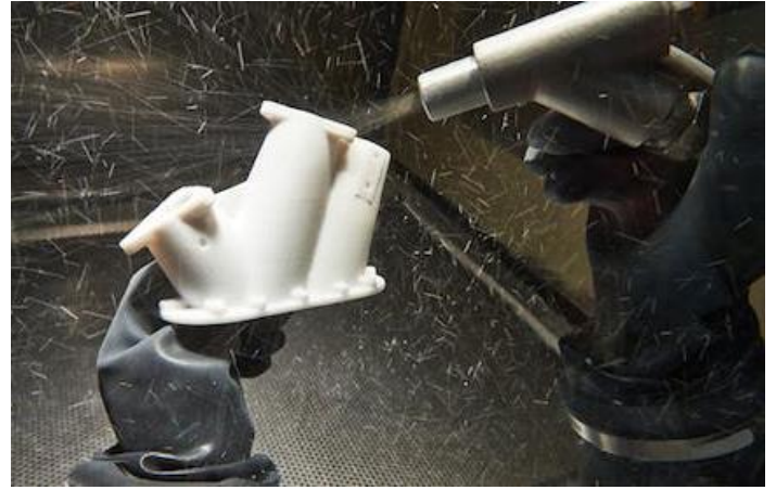
Εικόνα 3.9: Μετεπεξεργασία με βάψιμο του εκτυπωμένου αντικειμένου (Πηγή: Machine Design)
