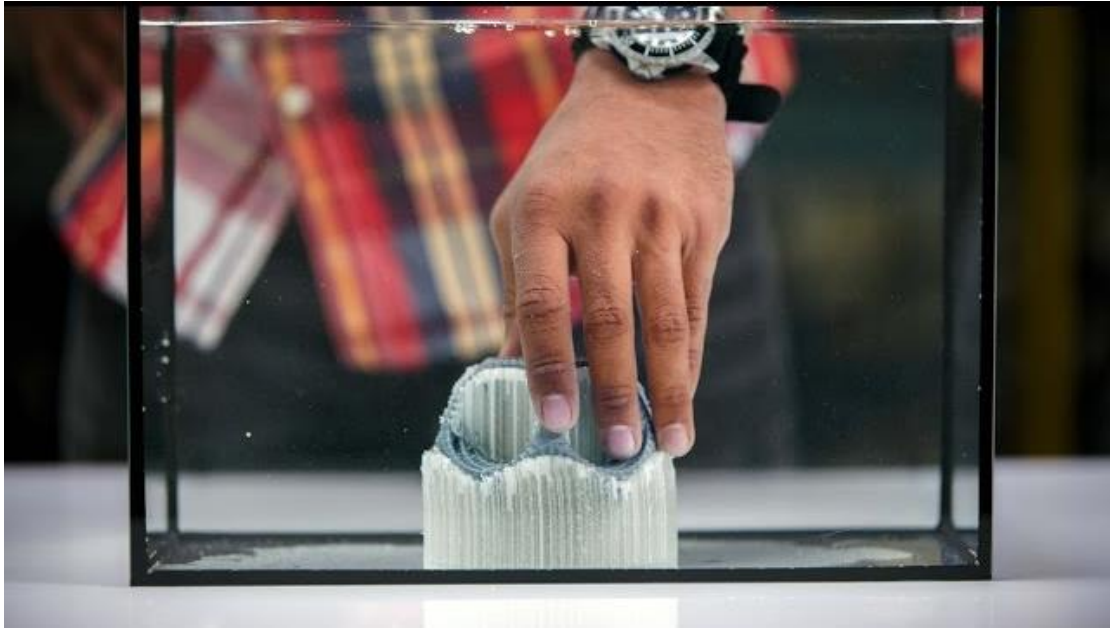
Εικόνα 3.6: Μετεπεξεργασία μέσω της διαδικασίας νεροδιαλυτής αφαίρεσης υλικού (Πηγή: MakerBot Support)
