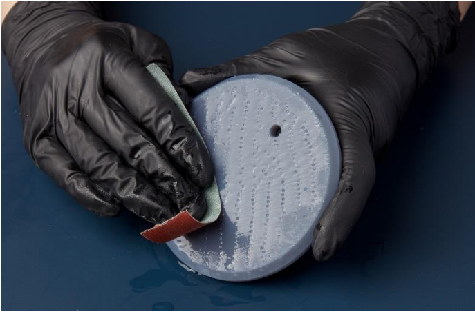
Εικόνα 3.8: Μετεπεξεργασία με τρίψιμο της επιφάνειας του εκτυπωμένου αντικειμένου (Πηγή: Formlabs)
