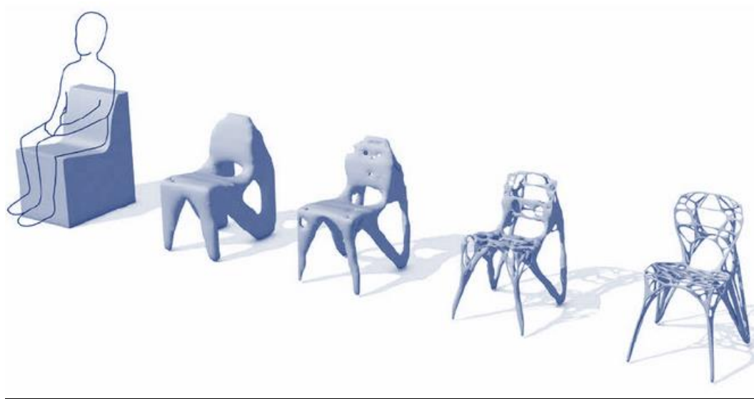
Εικόνα 39 Steps for creating optimized geometry
