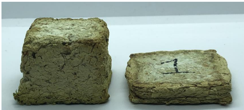
Εικόνα 44. Αριστερό δοκίμιο πριν την δοκιμή θλίψης, δεξιά δοκίμιο μετά την δοκιμή θλίψης
