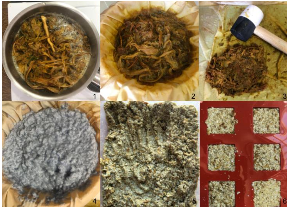
Εικόνα 24. Διαδικασία για παραγωγή χαρτιού με φυτικές ίνες
