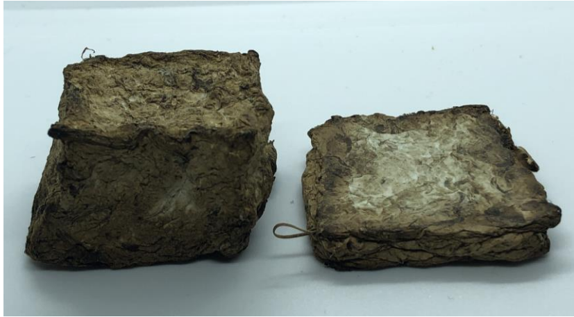
Εικόνα 46. Αριστερό δοκίμιο πριν την δοκιμή θλίψης, δεξιά δοκίμιο μετά την δοκιμή θλίψης
