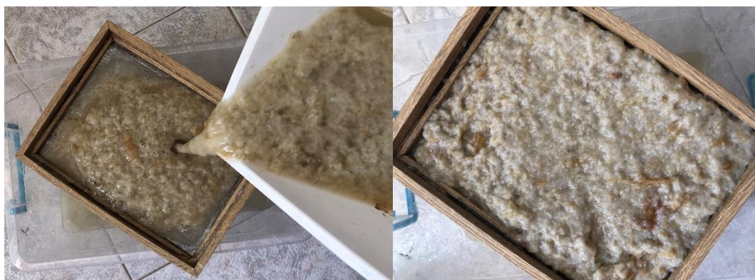
Εικόνα 25. Διαδικασία παραγωγής χαρτιού με φυτικές ίνες για εφελκυσμό
