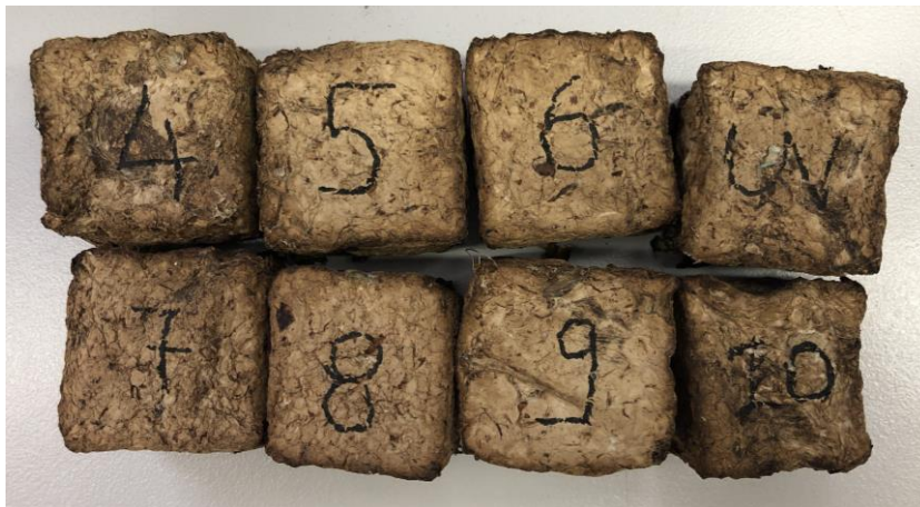
Εικόνα 41. Δοκίμια μπανάνας πριν υποβληθούν σε θλίψη
