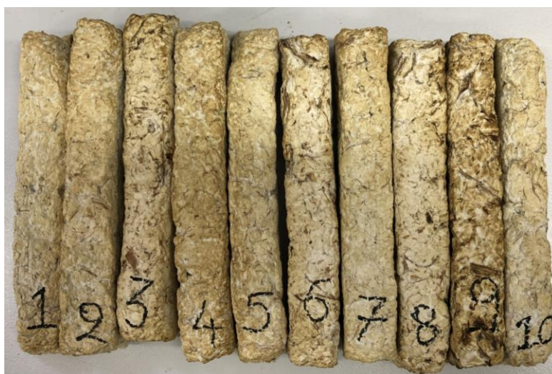
Εικόνα 36. Δοκίμια σέλερι πριν την δοκιμή σε κάμψη
