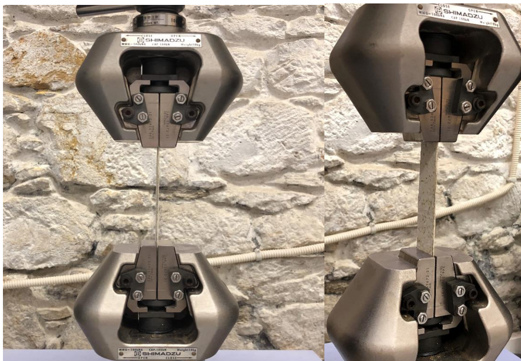
Εικόνα 28. Δοκιμή εφελκυσμού για υλικό από χαρτί και φυτικές ίνες
