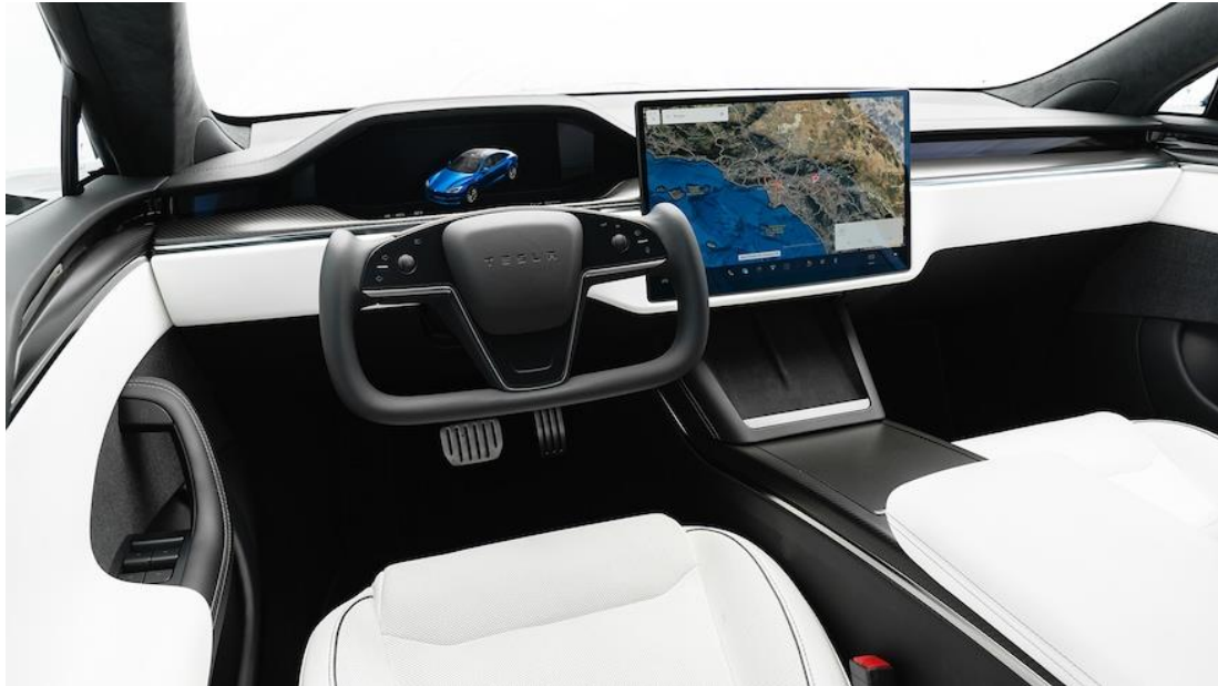
Εικόνα 7. Εσωτερικό του Tesla Model S Plaid, με τεράστια οθόνη ως βοήθημα και ελάχιστα αναλογικά χειριστήρια (Tesla, 2023).
