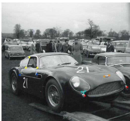
Εικόνα 3.6 : Τα μπλε , κίτρινα , πορτοκαλί , κόκκινα και πικουάζ σημεία, τα οποία μπορούν να θεωρηθούν κατάλληλα για την εφαρμογή σημείων αναφοράς (locators) επάνω τους.
