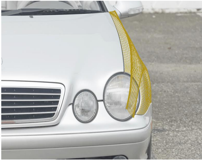
Εικόνα 5.8: Μοντελοποίηση του αριστερού φτερού με βάση τα αποτελέσματα της βαθμονόμησης της εικόνας 5.3.
