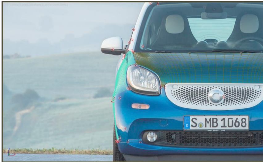
Εικόνα 5.20: Το αποτέλεσμα της μοντελοποίησης των φτερών και του καπό με βάση την βαθμονομημένη σκηνή των εικόνων 5.17 και 5.18.
