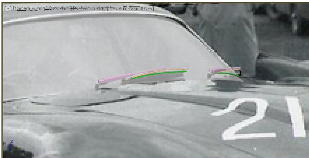
Εικόνα 4.81 : Δημιουργία των υαλοκαθαριστήρων και ταύτιση τους με τους υαλοκαθαριστήρες της φωτογραφίας.
