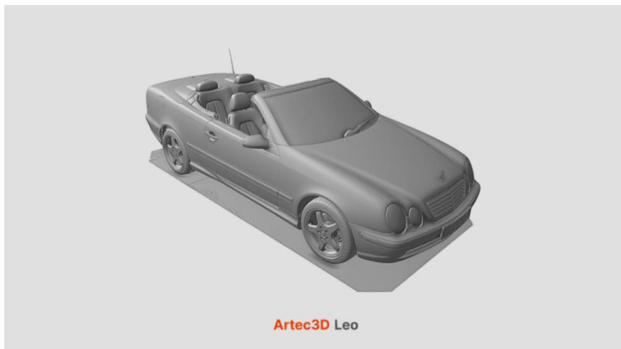
Εικόνα 5.1: Το μοντέλο της CLK 430. αποτελούμενο από ένα νέφος σημείων που δημιουργήθηκε μέσα από το σκανάρισμα του πραγματικού αυτοκινήτου.
