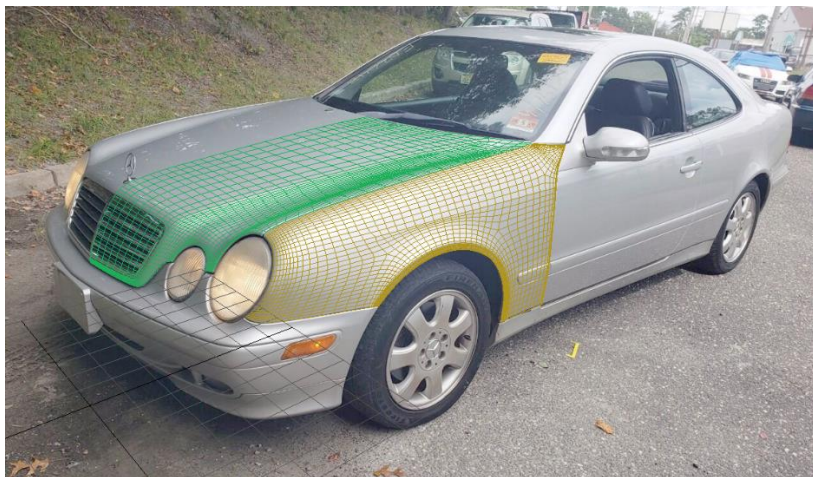
Εικόνα 5.9: Τοποθέτηση των μοντέλων του καπό και του φτερού με βάση τα αποτελέσματα της βαθμονόμησης της εικόνας 5.3.
