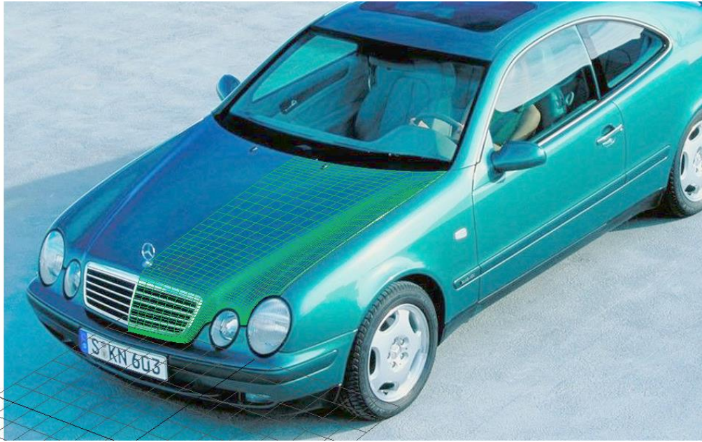
Εικόνα 5.5: Μοντελοποίηση του καπό με βάση τα αποτελέσματα της βαθμονόμησης της εικόνας 5.3.
