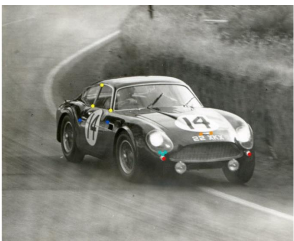
Εικόνα 3.6 : Τα μπλε , κίτρινα , πορτοκαλί , κόκκινα και πικουάζ σημεία, τα οποία μπορούν να θεωρηθούν κατάλληλα για την εφαρμογή σημείων αναφοράς (locators) επάνω τους.
