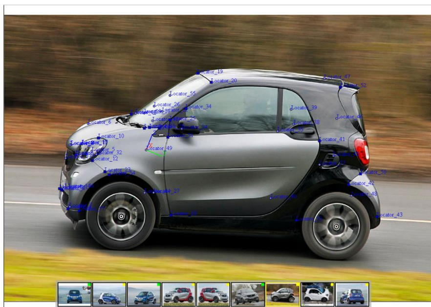
Εικόνα 5.18: Το αποτέλεσμα της βαθμονόμησης μέσα στο περιβάλλον του Image Modeler.
