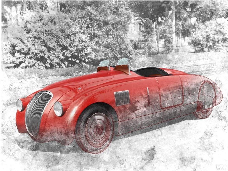
Εικόνα 2.2 : Το τρισδιάστατο,ψηφιακό μοντέλο της Lancia Aprilia Sport Zagato του 1938, τοποθετημένο πάνω σε μια φωτογραφία εποχής, η οποία, μαζί με άλλες, χρησιμοποιήθηκε για την “ανάσταση” της.
