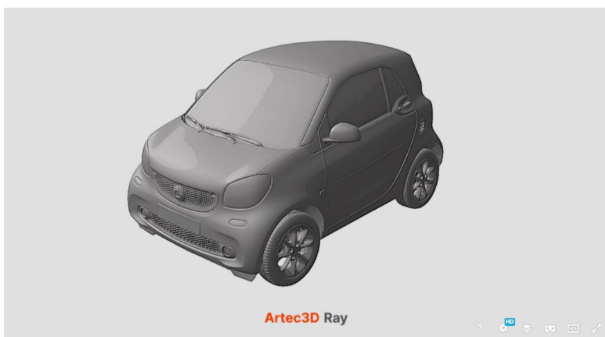
Εικόνα 5.1: Το μοντέλο του Smart Fortwo. αποτελούμενο από ένα νέφος σημείων που δημιουργήθηκε μέσα από το σκανάρισμα του πραγματικού αυτοκινήτου.
