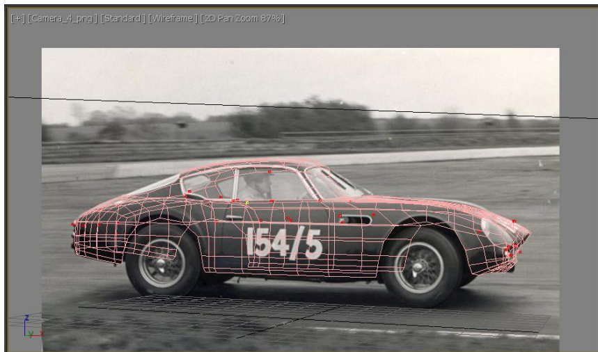
Εικόνα 4.21 : το μοντέλο του γενικού σχήματος, τοποθετημένο πάνω σε φωτογραφία για λόγους επαλήθευσης της πιστότητας του προς το πραγματικό αυτοκίνητο.
