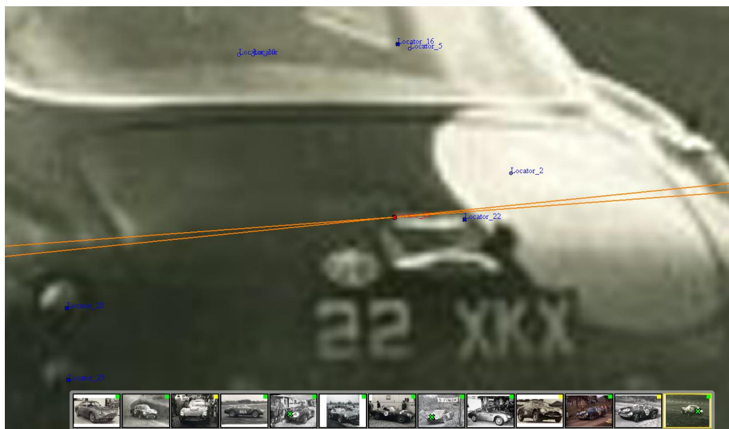
Εικόνα 3.39 : Παρά την κακή ποιότητα ορισμένων φωτογραφιών, το λογισμικό προσφέρει ακριβείς "οδηγούς" για να τοποθετηθούν τα σημεία αναφοράς σωστά.
