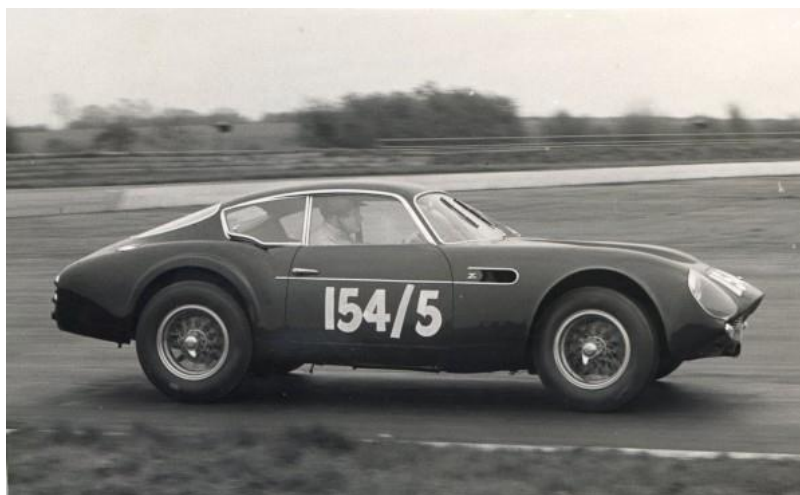
Εικόνα 3.2 : Η Aston Martin DB4 GT Zagato με αριθμό σασί 0200/R με τις μετατροπές που δέχθηκε (ελαφρώς φαρδύτερο φτερό πίσω, εισαγωγή αέρα κάτω από την γρίλια εμπρός) για τον αγώνα του Le Mans του 1962.
