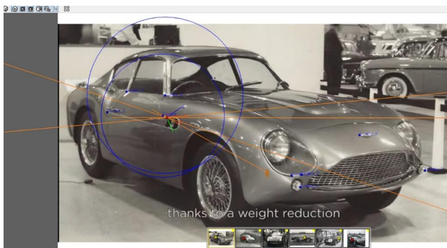
Εικόνα 3.20 : Έπειτα από την τοποθέτηση των πρώτων ευδιάκριτων σημείων, το λογισμικό έχει δημιουργήσει μερικές σχετικά βαθμονομημένες κάμερες.
