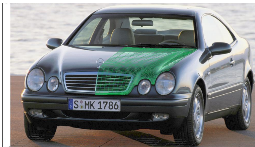
Εικόνα 5.4: Μοντελοποίηση του καπό με βάση τα αποτελέσματα της βαθμονόμησης της εικόνας 5.3.
