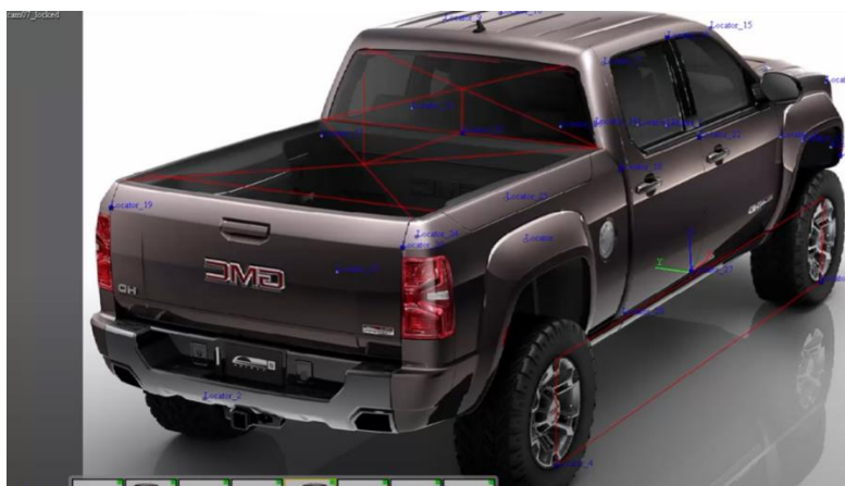
Εικόνα 2.16 : τοποθέτηση των locators και σε άλλη μια φωτογραφία, ώστε η τοποθεσία του κάθε locator στον χώρο να είναι σωστή.
