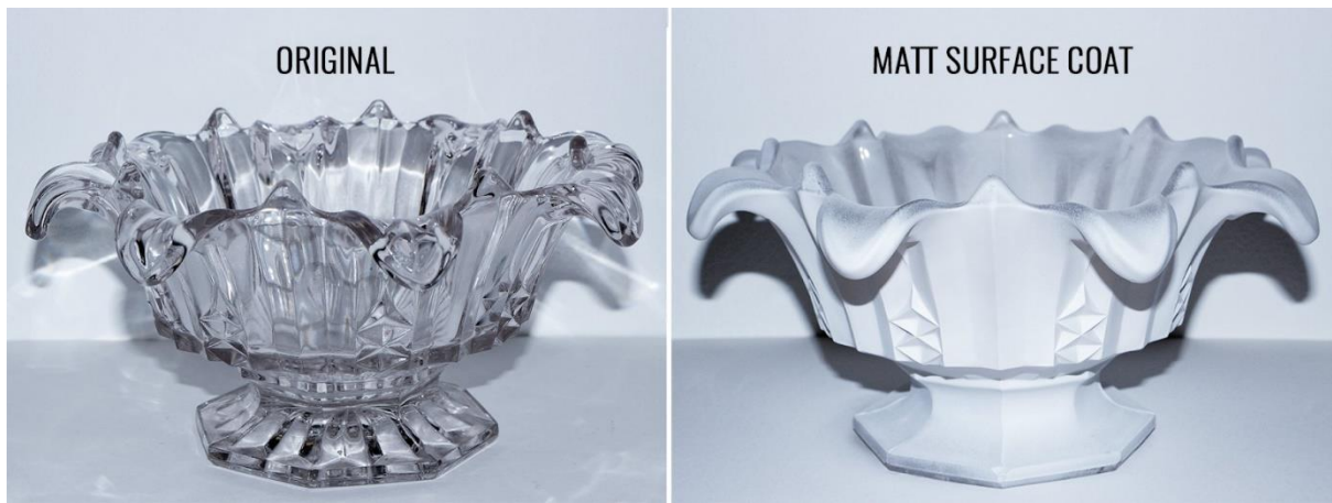
Εικόνα 1.5 : Ένα διάφανο και γυαλιστερό αντικείμενο καλύφθηκε με matte μπογιά, ώστε να μπορεί να αποτυπωθεί με ακρίβεια από το λογισμικό φωτογραμμετρίας.
