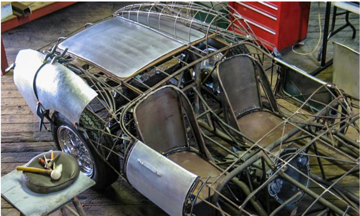
Εικόνα 1.3 : Το φύλλο αλουμινίου πρέπει να ακολουθήσει τις ασάλινες ράβδους/οδηγούς/τομές του σχήματος του αμαξώματος.
