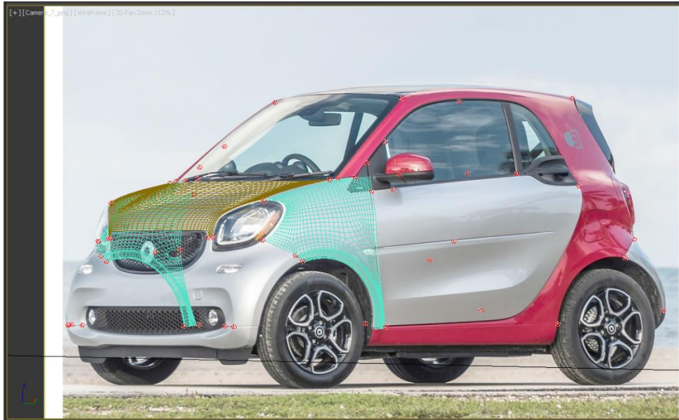
Εικόνα 5.22: Το αποτέλεσμα της μοντελοποίησης των φτερών και του καπό με βάση την βαθμονομημένη σκηνή των εικόνων 5.17 και 5.18.
