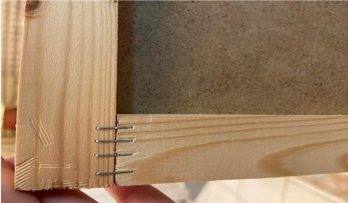
Εικόνα 79 Τα πηγάκια που στερεώθηκαν με το καρφωτικό
