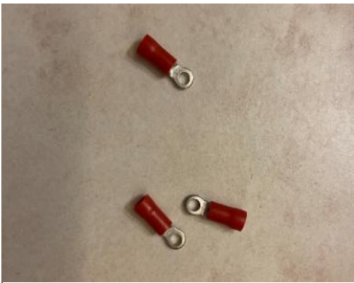
Εικόνα 82 Οι ακροδέκτες που χρησιμοποιήθηκαν για να συνδεθούν τα touchpoint με τα touch sensors της πλακέτας
