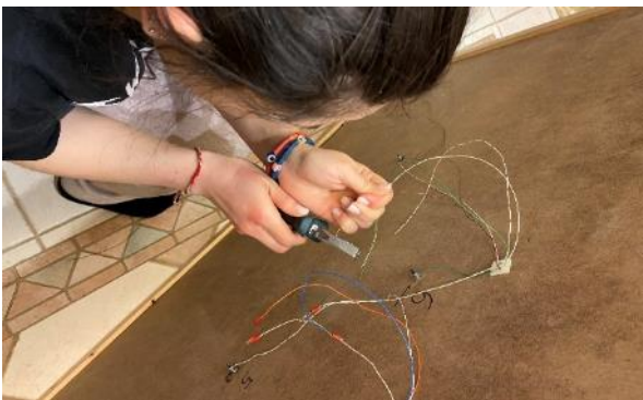
Εικόνα 83 Διαδικασία αφαίρεσης πλαστικού μέρους
