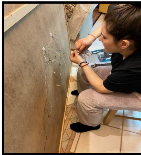
Εικόνα 89 Η σύνδεση έγινε κρατώντας προσεκτικά την πλακέτα και βιδώνοντας τις βίδες στα touch sensors
