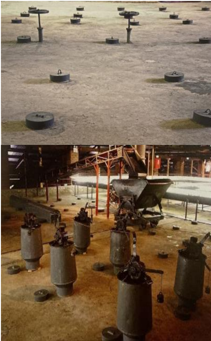
Εικόνα 49 Μηχανισμοί αυξομείωσης της φωτιάς
