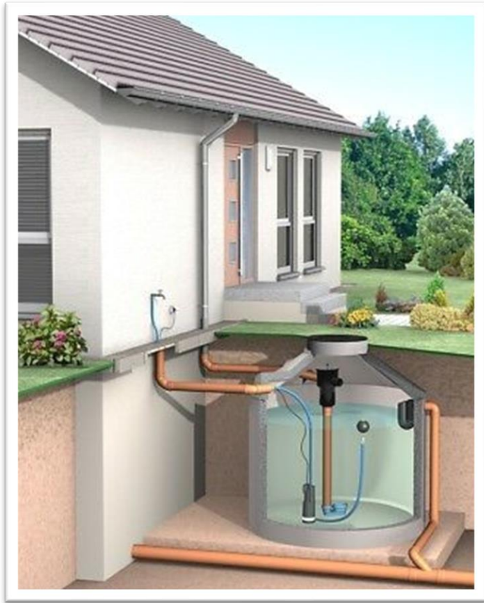
Σχέδιο 7.2. 18 Δεξαμενή – παράδειγμα συστήματος εσωτερικά
