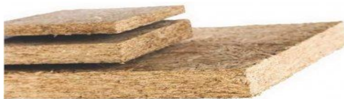
Εικ 52 Τελικό προϊόν Typhaboard. (Φωτογραφία: typha technik) (Geuder, 2013)
