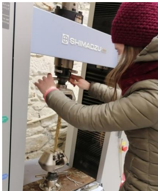
Εικ 72 Τοποθέτηση δοκιμίου στο μηχάνημα εφελκυσμού
