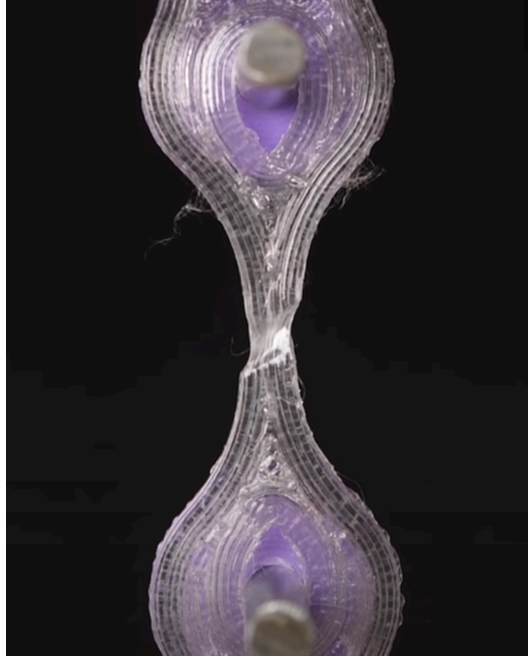
Εικ. 24 - Τεστ αντοχής σε εφελκυσμό(σωστή εκτύπωση, άμορφο, διάφανο κομμάτι, ελαστική παραμόρφωση στο σημείο θραύσης)(CNC Kitchen, 2022)
