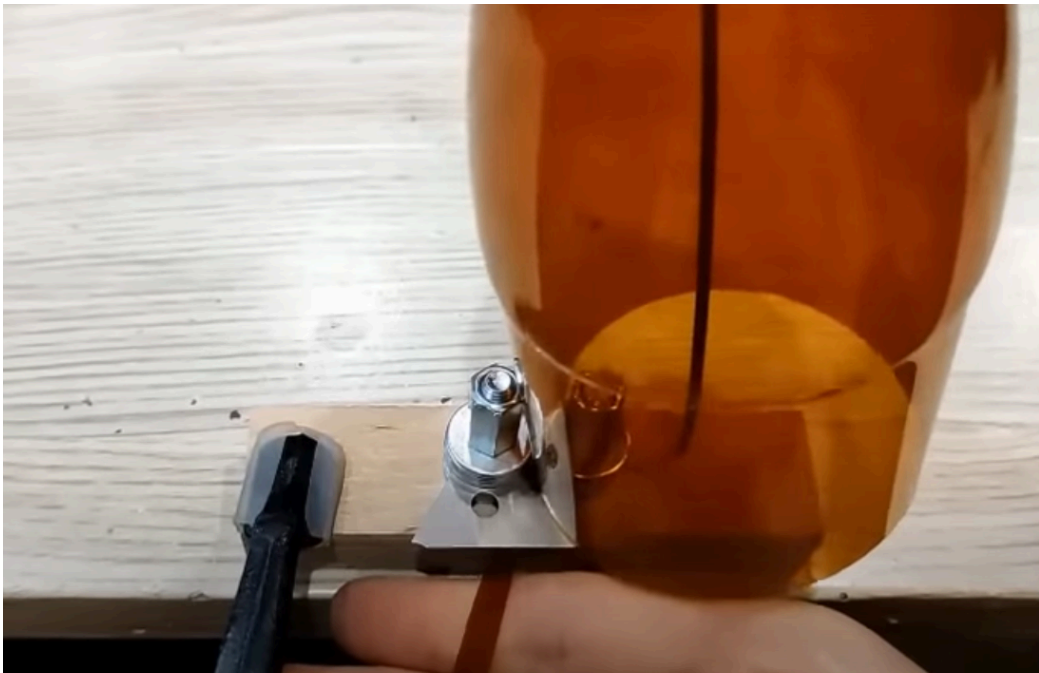
Εικ.11 - 1) Τοποθέτηση της λεπίδας ανάμεσα από τις ροδέλες 2)Συστημα κοπής μπουκαλιών με φαλτσέτα και ροδέλες σε χρήση (Plastic bottle cutter, 2021)
