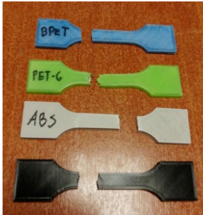
Εικ. 18 - φωτογραφία από έρευνα αντοχής εκτυπωμένων δοκιμών (σωστή διεύθυνση εκτύπωσης αλλά εμφανώς ημικρυσταλλικό αδιάφανο B-PET)(Tylman & Dzierzek, 2020)
