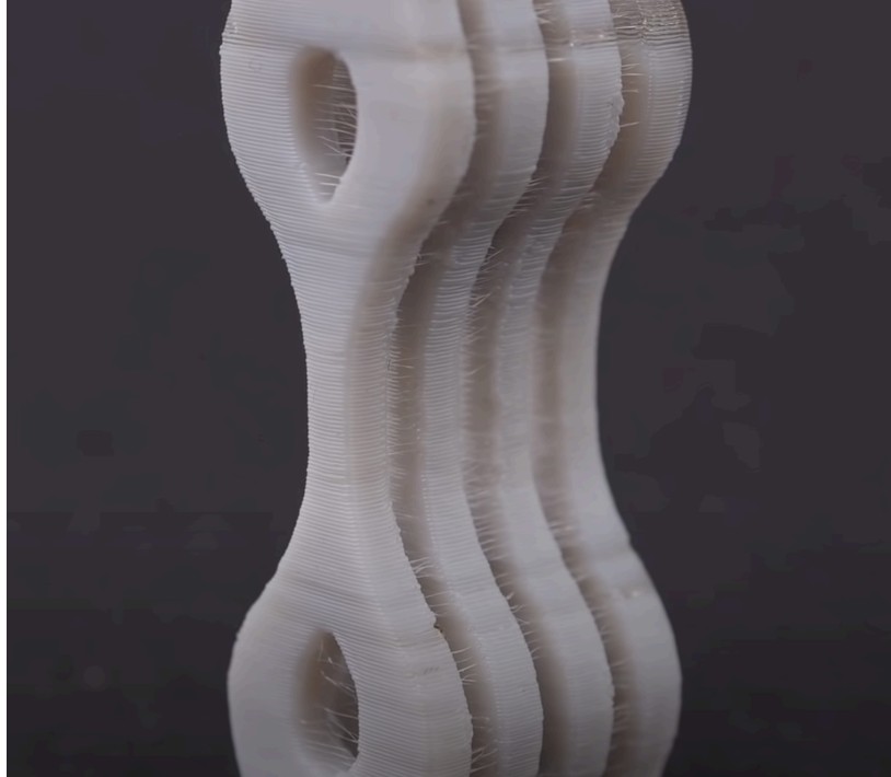
Εικ. 22 - Τα κάθετα τυπωμένα ημικρυσταλλικά κομμάτια.(CNC Kitchen, 2022)
