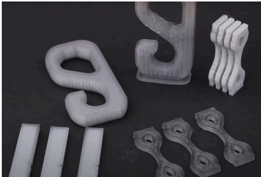
Εικ. 21 - Κομμάτια που τυπώθηκαν άμορφα δίπλα σε ημικρυσταλλικά διάφορων ποσοστών κρυσταλλικότητας.(CNC Kitchen, 2022)
