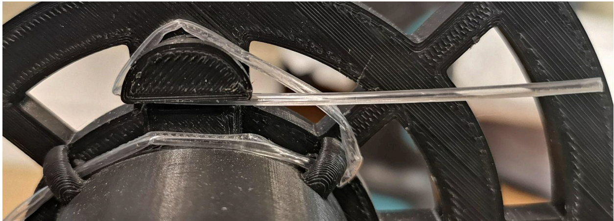
Εικ. 67 - Εκτυπωμένο μεγάλο γρανάκι - καρούλι νήματος. Ασφάλιση νήματος με χρήση των σχεδιασμένων χαρακτηριστικών του σχεδίου (1η τεχνική)
