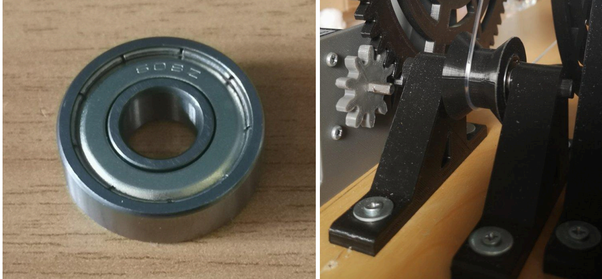
Εικ. 78 - 1) Είδος ρουλεμάν που χρησιμοποιείται στην τροχαλία 2) Εκτυπώσεις κομματιών και ρουλεμάν σε συναρμολόγηση σε χρήση
