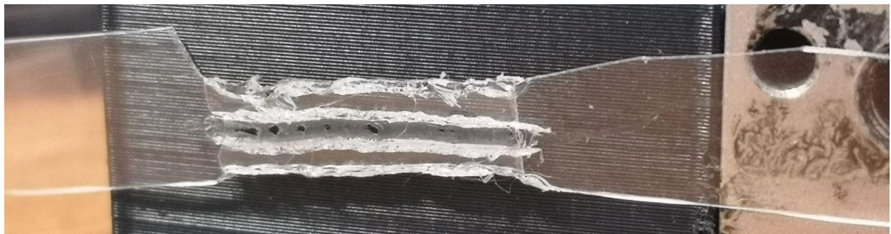
Εικ. 124 - 1) Σχεδιάγραμμα για την ένδειξη των σημείων και της κατεύθυνσης των περασμάτων του κολλητηριού 2) Φωτογραφία για την ένδειξη του αποτελέσματος της επιτυχημένης τεχνικής ένωσης λωρίδων και ειδικότερα για την ένδειξη του “χαντακιού” που διαμορφώνουν τα μεσαία περάσματα του κολλητηριού
