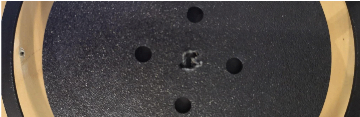
Εικ. 127 - 1) Στιγμιότυπο από το σχέδιο του πάνω κομματιού του καρουλιού λωρίδας που φαίνονται οι τέσσερις οπές στο κέντρο 2) Εκτυπομένο πάνω κομμάτι του καρουλιού λωρίδας μετά από χρήση του, με εμφανή πληγή στο υλικό από το δραπενοκατσάβιδο
