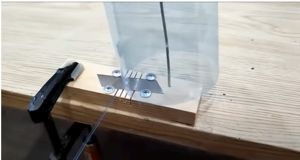
Εικ. 12 Σύστημα κοπής μπουκαλιών με φαλτσέτα και εσοχές σε χρήση (Plastic bottle cutter, 2021)
