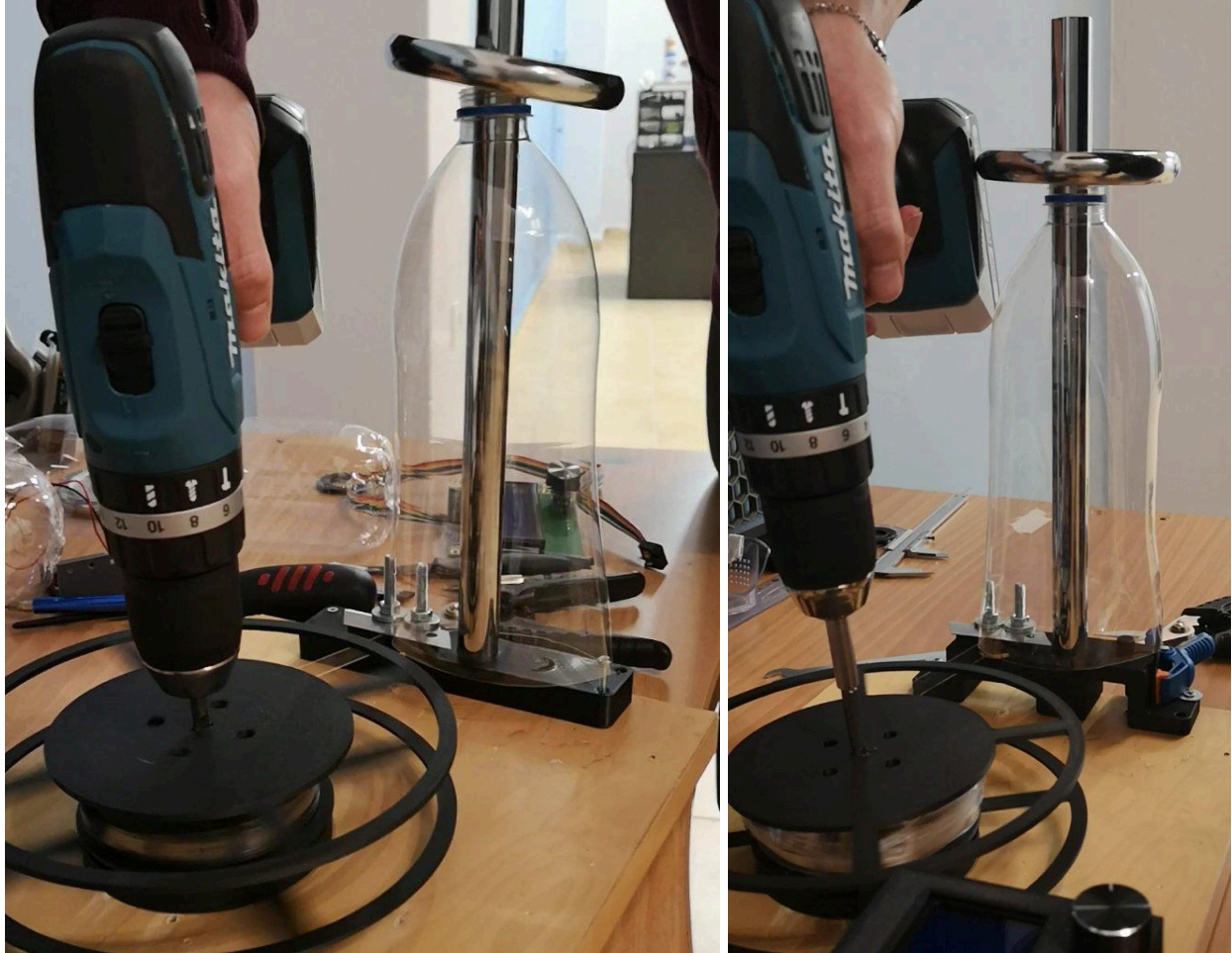
Εικ. 115 - 1,2,4,5) Εικόνες από την διαδικασία κοπής και τύλιξης των λωρίδων με το σύστημα τύλιξης και έλξης λωρίδων 3) Σχέδιο προεξοχής για το γάντζωμα της λωρίδας
