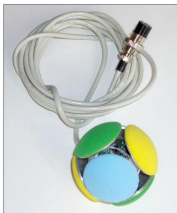
ΕΙΚΟΝΑ 4 : ΑΠΛΟ LOAD CELL ΕΝΟΣ ΑΞΟΝΑ (ΟΜΟΙΟ ΜΕ ΑΥΤΑ ΠΟΥ ΘΑ ΧΡΗΣΙΜΟΠΟΙΗΘΟΥΝ ΣΤΗΝ ΕΡΓΑΣΙΑ)
