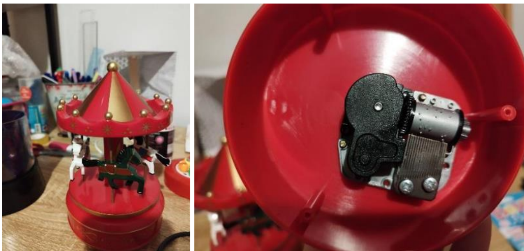
Figure 84: Χρήση κουρδιστού μηχανισμού, από παιχνίδι καρουζέλ, για την περιστροφή
