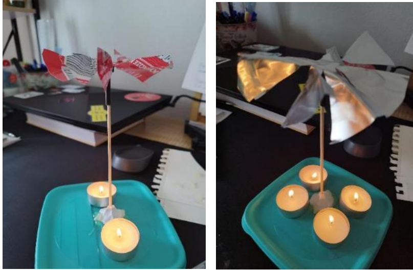
Figure 83: Δοκιμή περιστροφής με τη χρήση ζεστού αέρα
