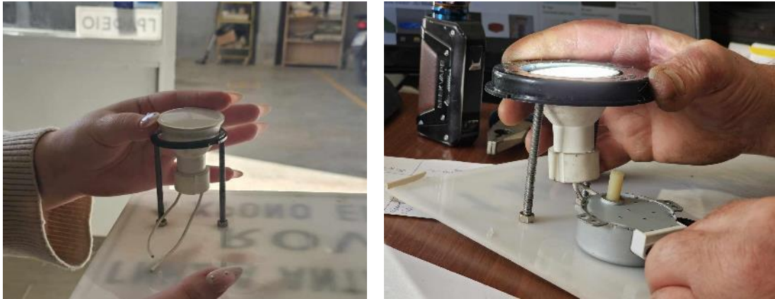
Figure 112: Δυνατότητα αλλαγής της λάμπας από το χρήστη, με το συγκεκριμένο τρόπο τοποθέτησης του μηχανισμού
