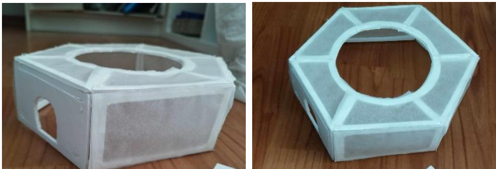
Figure 130: Δοκιμή διάτρητης βάσης για την αποφυγή μεγάλου όγκου στο κάτω μέρος
