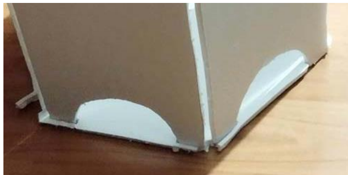
Figure 131: Δημιουργία καμπυλών για να περνάει ο ροοστάτης και το καλώδιο
