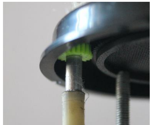
Figure 128: Η σύνδεση των γραναζιών για την περιστροφή
