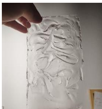
Figure 86: Δημιουργία νέου καλουπιού για το γυαλί σε μεγαλύτερες διαστάσεις
