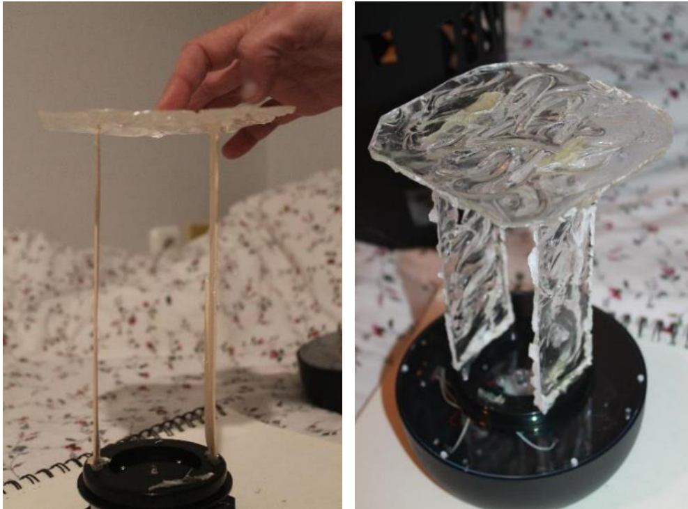
Figure 108: Δοκιμές γυαλιού με στήριξη από ξύλο αλλά και από το ίδιο το γυαλί
