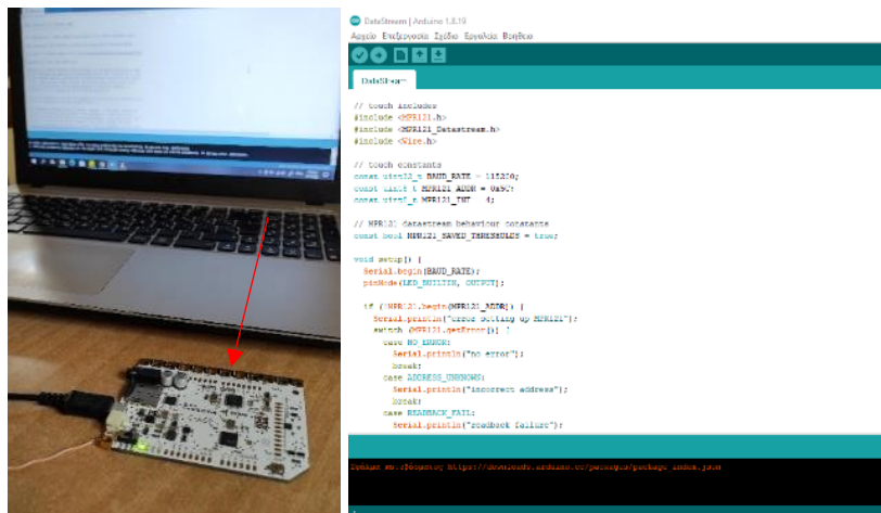
Εικόνα 4.33 (αριστερά): Δοκιμές του κώδικα με χρήση της πλακέτας. Το βέλος δείχνει τα ηλεκτρόδια αφής.
