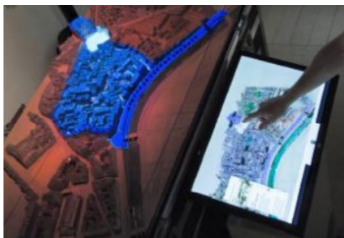
Εικόνα 2.18: Το αντίγραφο του λιμανιού με χαρτογράφηση προβολής και διάδραση σε TUI
