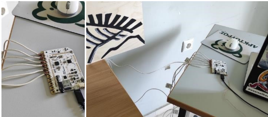
Εικόνα 5.16: Διακρίνεται το δέσιμο των καλωδίων στα electrodes.
