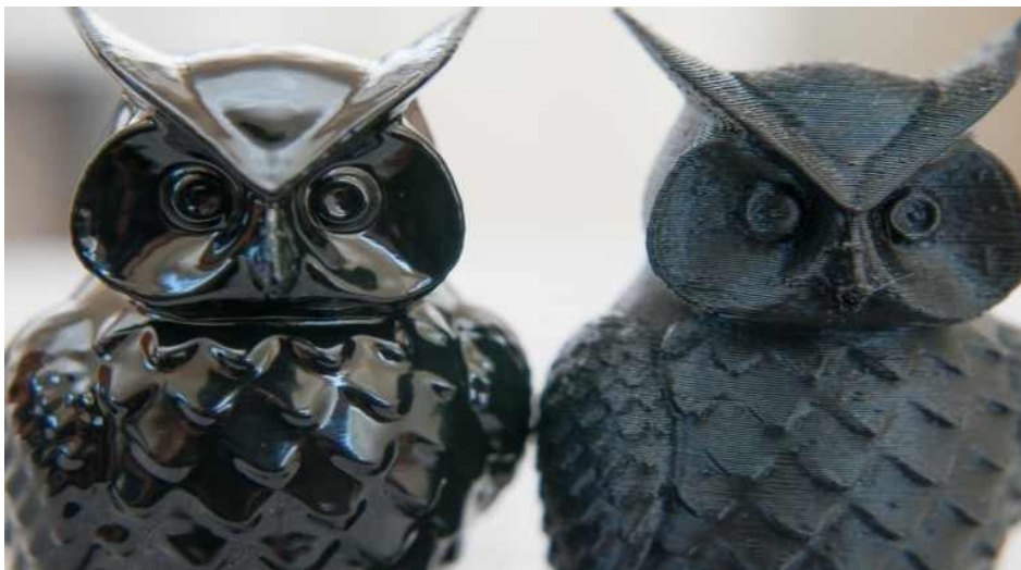
Εικόνα 2-28. Δεξιά απεικονίζεται το αντικείμενο που δεν έχει δεχτεί επεξεργασία και αριστερά φαίνεται πως είναι μετά την λείανση και την βαφή του.
