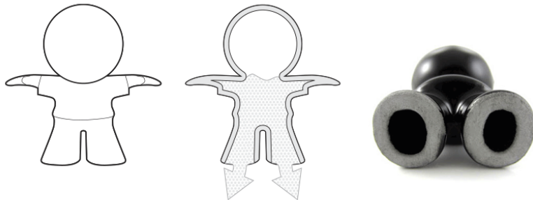
Εικόνα 3-4. Αντικείμενο με κούφιο εσωτερικό το οποίο θα κατασκευαστεί με ρητίνη. Στο χαμηλότερο σημείο του έχουν γίνει οπές για να ελευθερωθεί η ρητίνη που δεν πολυμερίστηκε.
