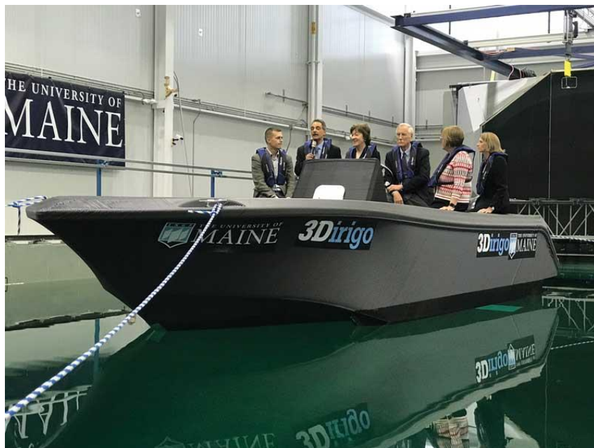
Εικόνα 4-10. Σκάφος κατασκευασμένο εξ ολοκλήρου από 3D εκτυπωτή.
