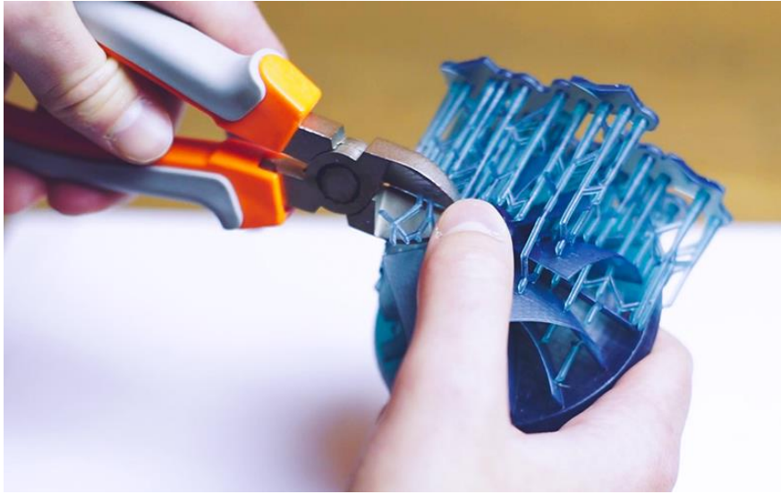
Εικόνα 2-27. Αφαίρεση υποστηρικτικών δομών.
