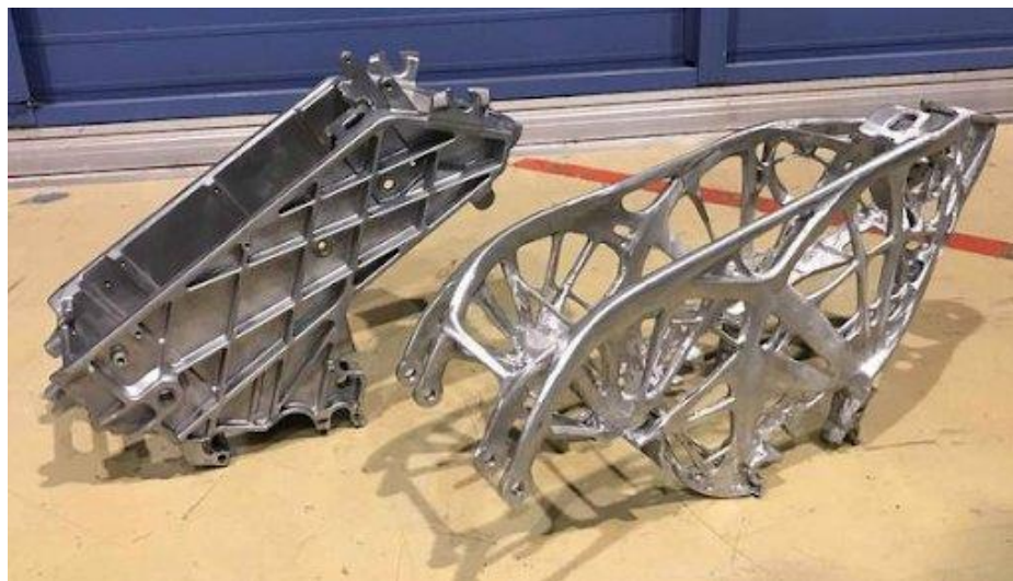
Εικόνα 5-2. Επανασχεδίαση σκελετού με την χρήση του generative design πετυχαίνοντας μείωση 40% του βάρους.
