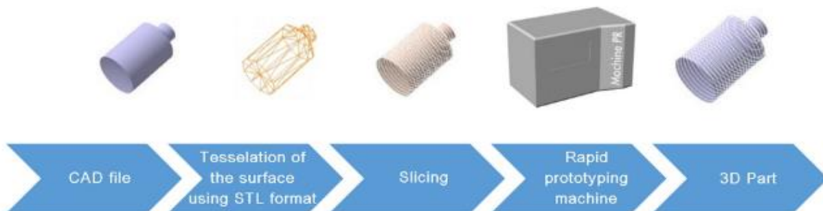
Εικόνα 2-19. Τα πέντε στάδια της προσθετικής κατασκευής.
