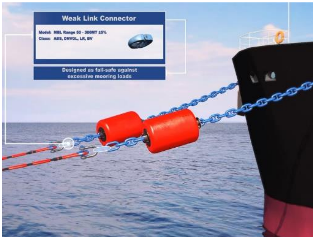
Εικόνα 6-9. Κρίκος ο οποίος τοποθετείται ανάμεσα στο σκοινί και στην αλυσίδα του πλοίου. Είναι σχεδιασμένος για να σπάει όταν δεχθεί μεγάλες τάσεις, ώστε να προστατεύει τα υπόλοιπα εξαρτήματα.
