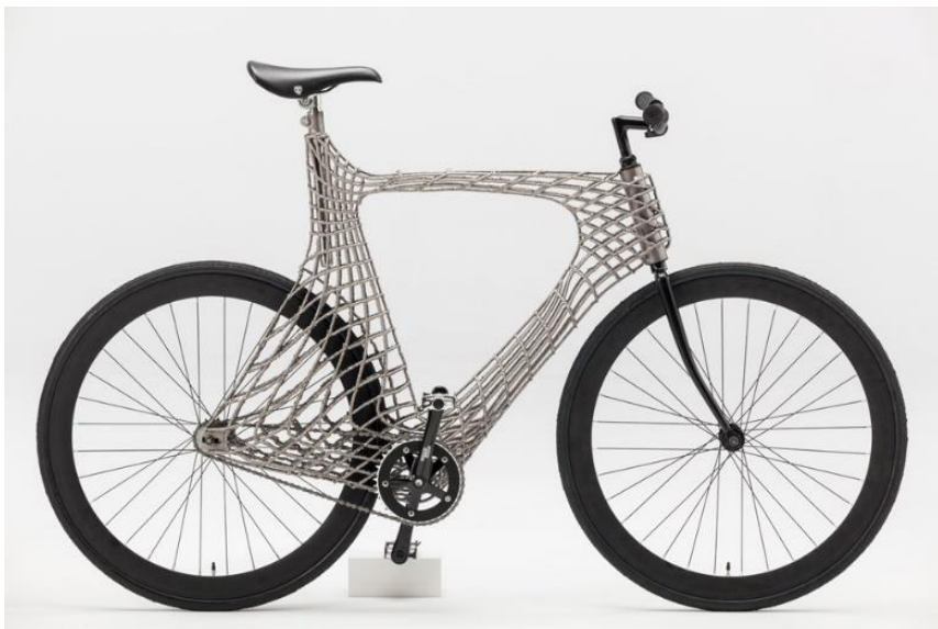
Εικόνα 4-12. Σκελετός ποδηλάτου κατασκευασμένος με προσθετική κατασκευή.
