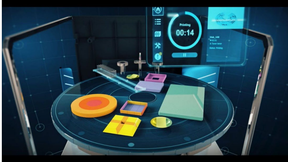
Εικόνα 73 Περιστρεφόμενη πλατφόρμα εκτύπωσης, με στατική κεφαλή εκτύπωσης, παρέχει συνεπή εκτύπωση υλικού και γρήγορους χρόνους εκτύπωσης. Πηγή: [all3dp]
