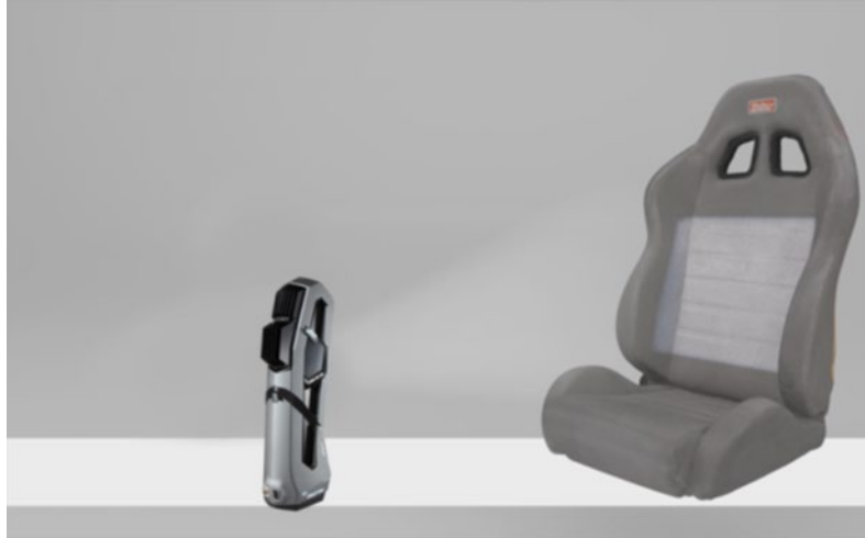
Εικόνα 29 Ο σαρωτής χρειάζεται γεωμετρία για να τοποθετηθεί στον χώρο. Πηγή: [Creaform3d]
