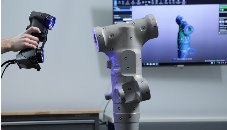
Εικόνα 12 Ο σαρωτής καθορίζει τη θέση του αντικειμένου χρησιμοποιώντας τα χαρακτηριστικά της σαρωμένης επιφάνειας (συνήθως κολλητικοί ανακλαστικοί στόχοι). Πηγή: [creaform3d]
