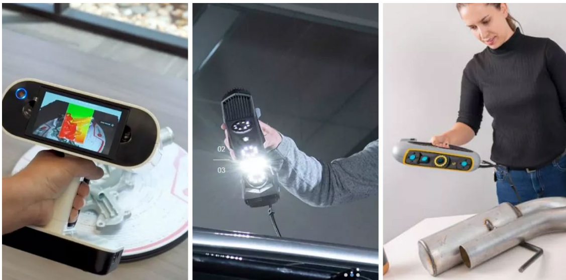
Εικόνα 15 Οι σαρωτές δομημένου φωτισμού αποκτούν δεδομένα εκπέμποντας λευκό φως. Πηγή [goengineer]
