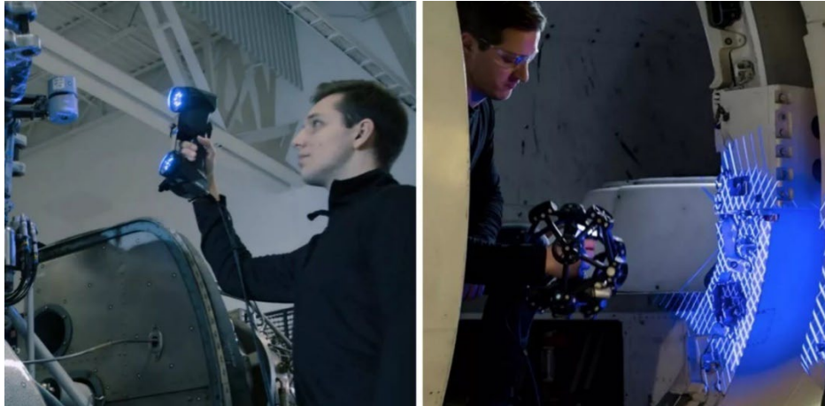
Εικόνα 14 Οι σαρωτές λέιζερ 3D προβάλλουν ακτίνες λέιζερ στην επιφάνεια του εκάστοτε αντικειμένου που σαρώνουν και καταγράφουν σημεία. Πηγή: [goengineer]
