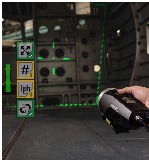
Εικόνα 20 Χρήση της φωτογραμμετρία στις τρισδιάστατη σάρωση. Πηγή: [Creaform3d]
