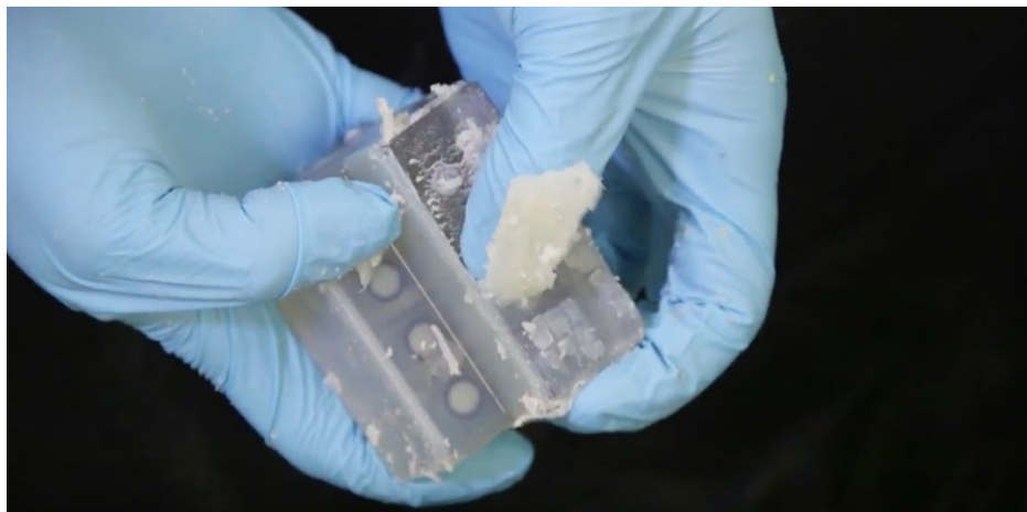
Εικόνα 82 Αφαίρεση υλικού υποστήριξης. Πηγή: [GrabCAD]
