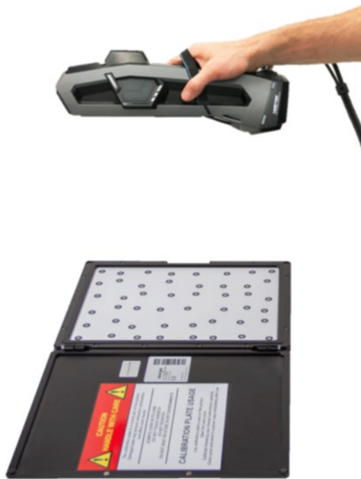
Εικόνα 32 Μέσω της βαθμονόμησης, βελτιστοποιούνται και διατηρούνται τα αρχικά χαρακτηριστικά μέτρησης Πηγή: [Creaform3d]
