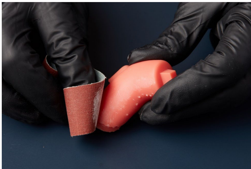
Εικόνα 83 Η λείανση είναι η πιο συνηθισμένη μορφή μετα-επεξεργασίας. Πηγή: [formlabs]
