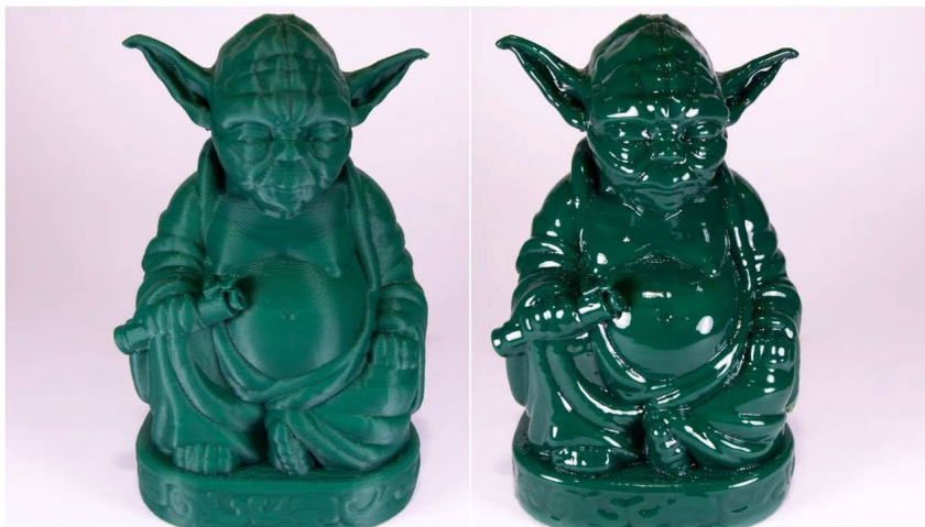
Εικόνα 86 Αριστερά πριν την εξομάλυνση επιφάνειας και δεξιά το μετά. Πηγή: [all3d]
