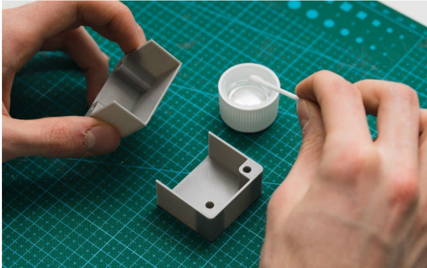
Εικόνα 84 Εφαρμογή συγκόλλησης δύο κομματιών. Πηγή: [hubs]
