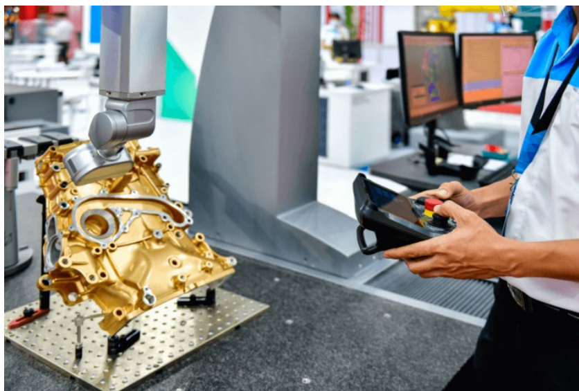
Εικόνα 6 Οι γεωμετρικές συντεταγμένες του αντικειμένου μετρούνται με CMM και ο χειριστής ελέγχει το μηχάνημα χειροκίνητα. Πηγή [Artec3d]
