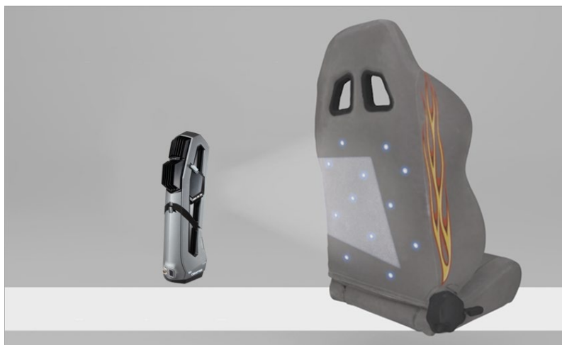
Εικόνα 30 Η έξυπνη υβριδική τοποθέτηση συνδυάζει τους στόχους θέσης με τις πληροφορίες γεωμετρίας. Πηγή: [Creaform3d]
