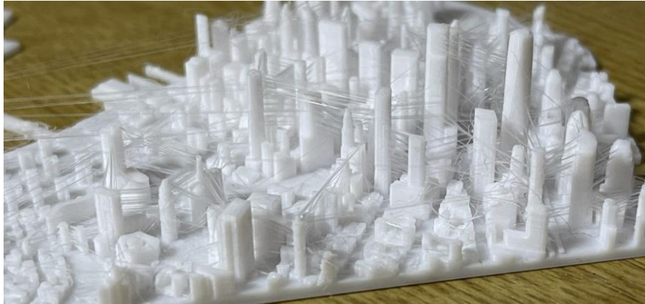
Εικόνα 3. 99 Παράδειγμα 'κλωστών' από εκτύπωση
