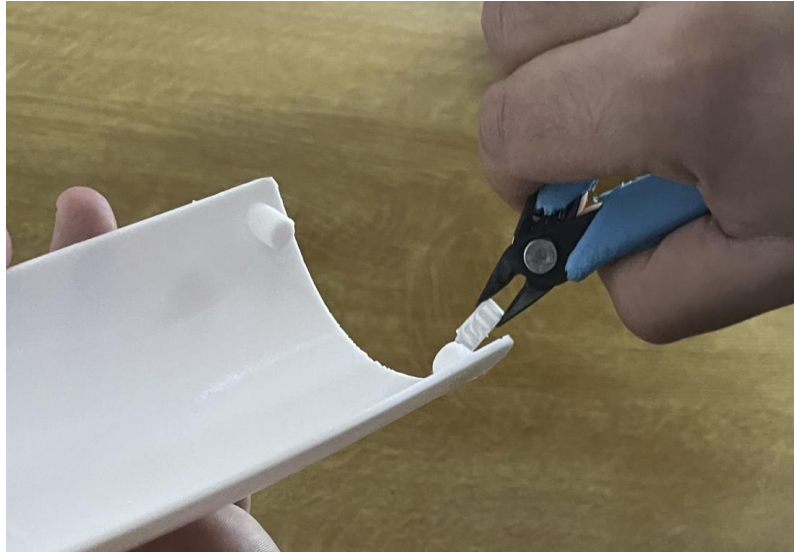
Εικόνα 3. 97 Παράδειγμα αφαίρεσης support
