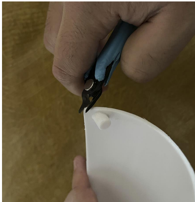
Εικόνα 3. 98 Παράδειγμα αφαίρεσης ατελειών εκτυπωμένου κομματιού
