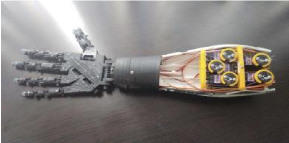
Εικόνα 1. 2 Υλοποίηση InMoov αντιβραχίου για δεύτερο πείραμα βιθλιογραφίας[4]
