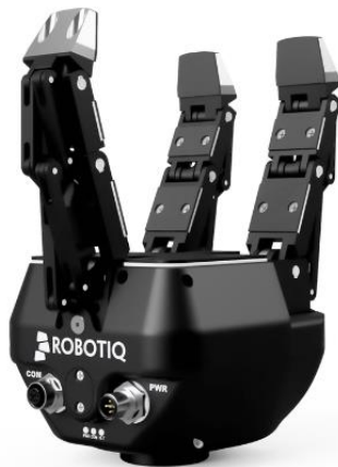
Εικόνα 3. 5 Παράδειγμα χεριού με 3 δάχτυλα[29]
