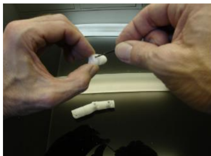
Εικόνα 1. 11 κατασκευή δαχτύλου InMoov[5]
