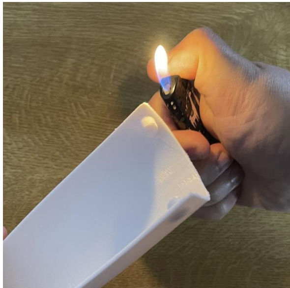
Εικόνα 3. 100 Παράδειγμα αφαίρεση ατελειών
