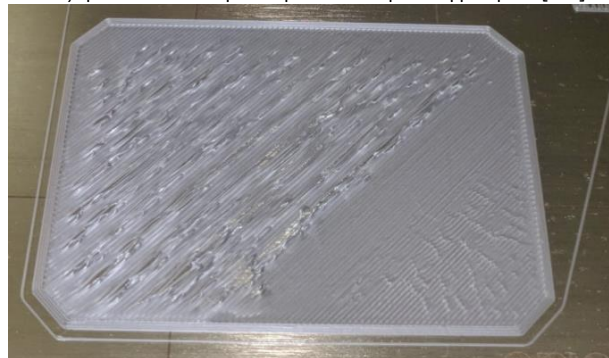
Εικόνα 3. 90 Παράδειγμα μη κάθετου κρεβατιού σε σχέση με το nozzle[46]
