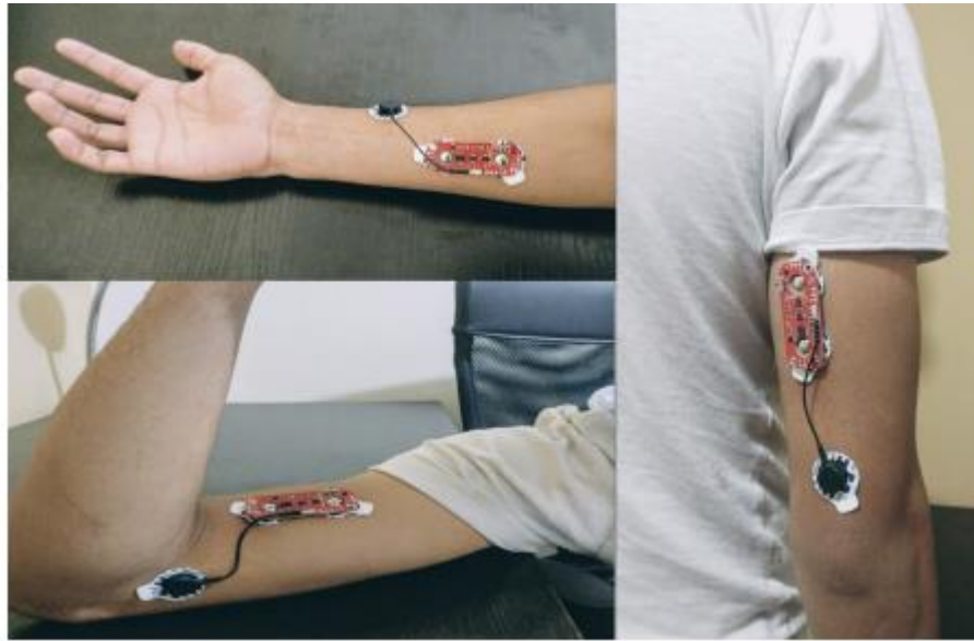
Εικόνα 1. 6 θέση αισθητήρα EMG από βιβλιογραφία[4]
