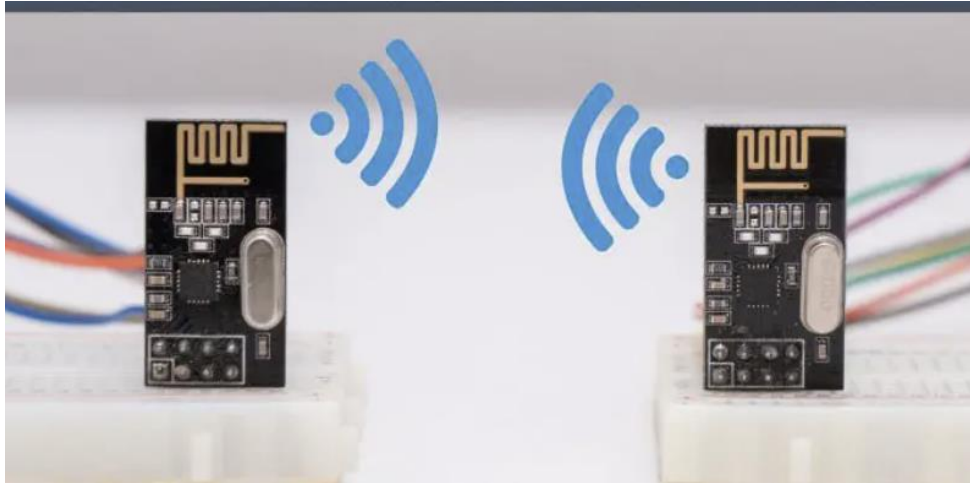
Εικόνα 3. 63 ένδειξη ασύρματης επικοινωνίας NRF24L01[22]
