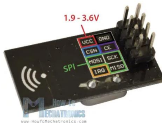
Εικόνα 3. 64 NRF24L01 pins[22]
