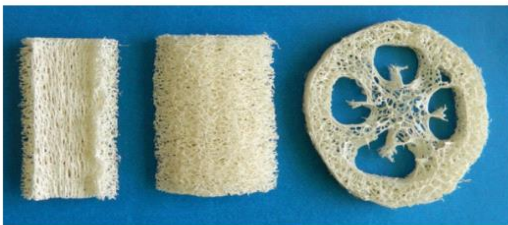
Εικόνα 46: Προσανατολισμός ινών λούφα (αριστερά: εσωτερική επιφάνεια, μέση: εξωτερική επιφάνεια, δεξιά: διατομή).
