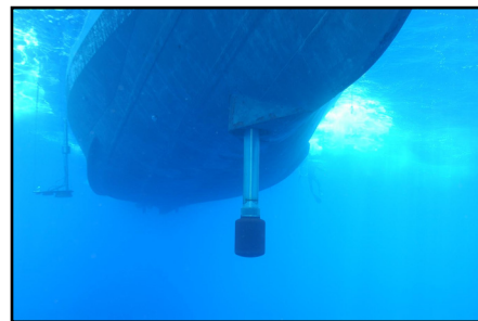
Εικόνα 2-1: Ο μεταλλάκτης του SIMRAD SP90 στην καρίνα του ερευνητικού σκάφους.
