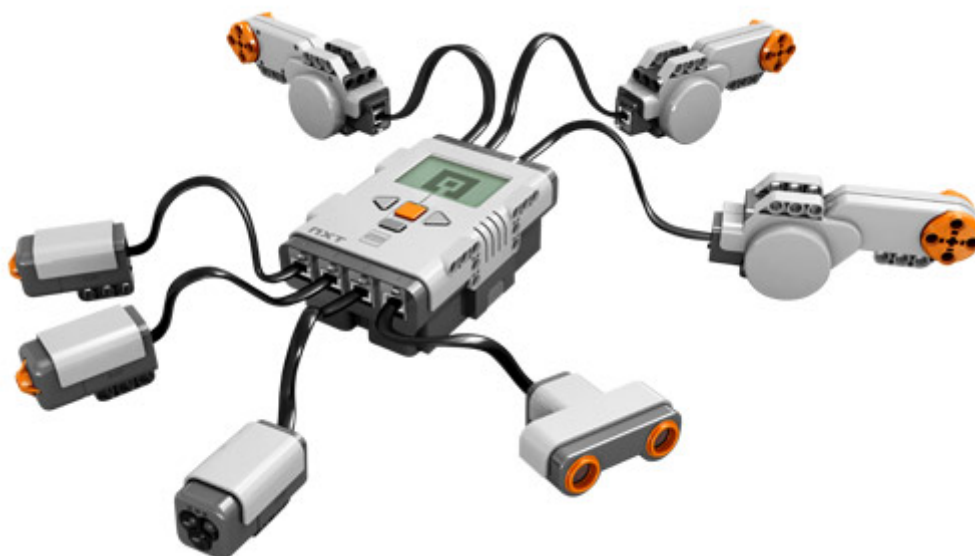
Εικόνα 3 Το nxt με τους αισθητήρες (δύο αισθητήρες πίεσης, φωτός, υπερήχων και τρία μοτέρ συνδεδεμένα)
