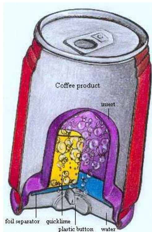
Σχ.3.6 Τομή αυτό-θερμαινόμενης συσκευασίας, προϊόν της TDL και του Πανεπιστημίου του Southampton.
