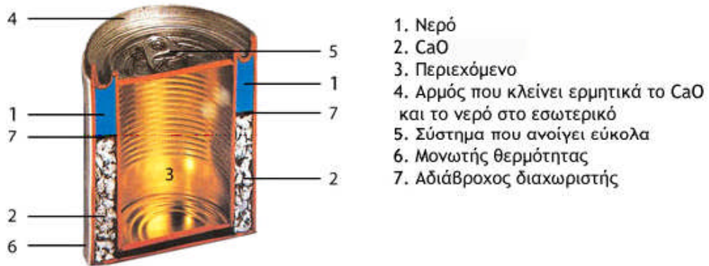
Σχ. 3.10 Τομή αυτό-θερμαινόμενης συσκευασίας φαγητού
