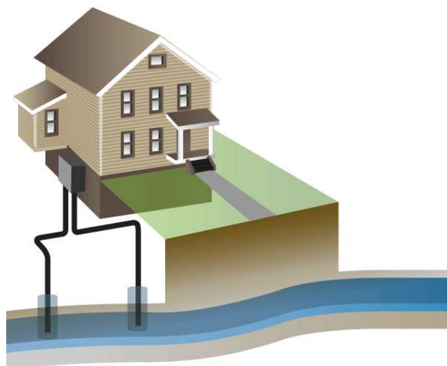
Εικόνα 75 Σύστημα ανοιχτού βρόχου ( www.ghp-ma.gr )
