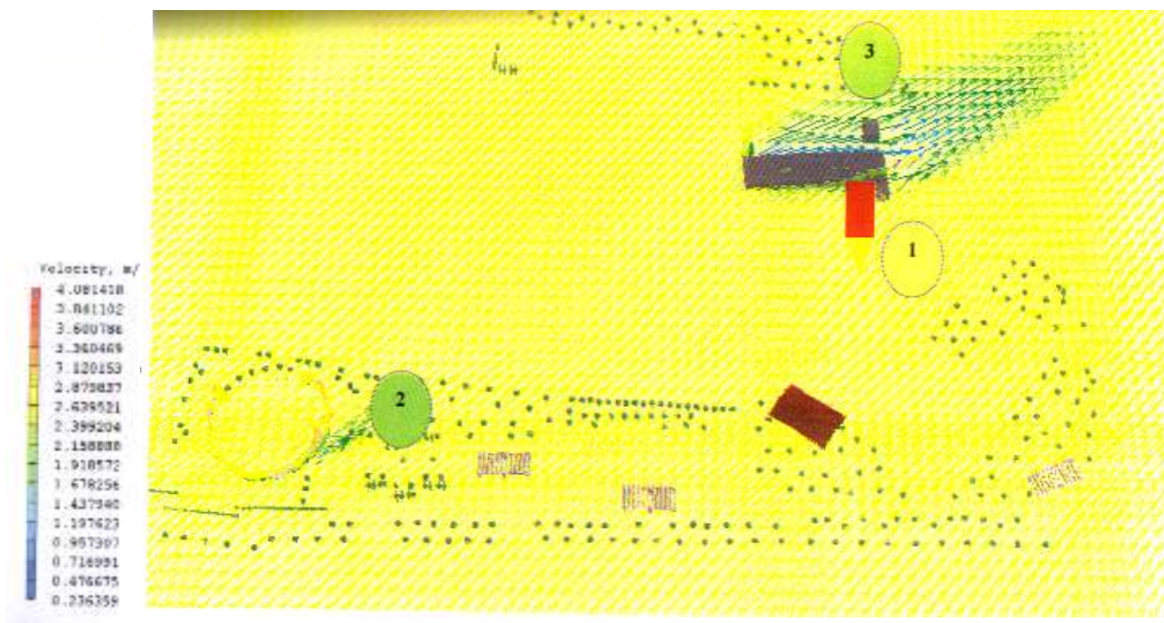
Εικόνα 16 Κατανομή του πεδίου ταχυτήτων του αέρα σε ύψος 1.5m για τη θερινή περίοδο και άνεμο ΝΑ διεύθυνσης (Πανεπιστήμιο Αθηνών, τμήμα φυσικής, τομέας εφαρμογών, 2008)
