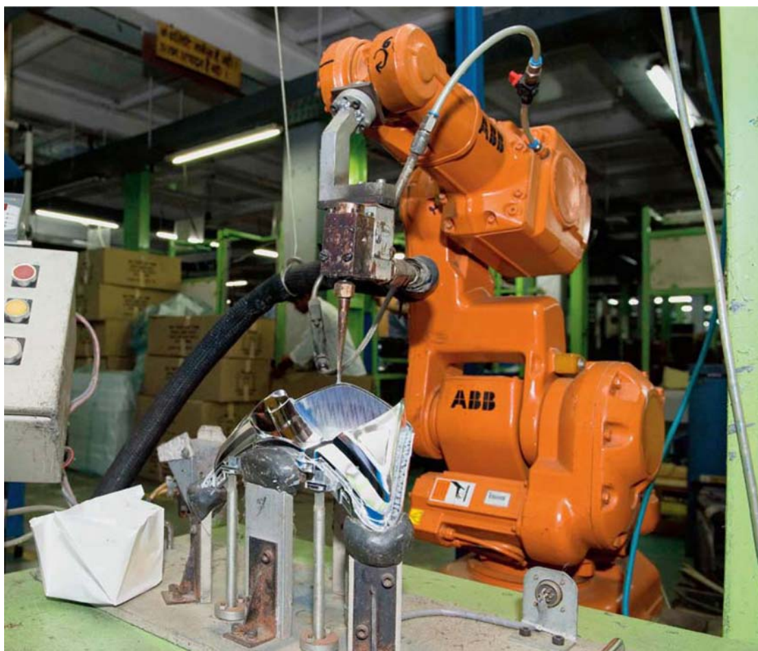
Εικόνα 27 Ρομπότ σε εφαρμογή συναρμολόγησης
