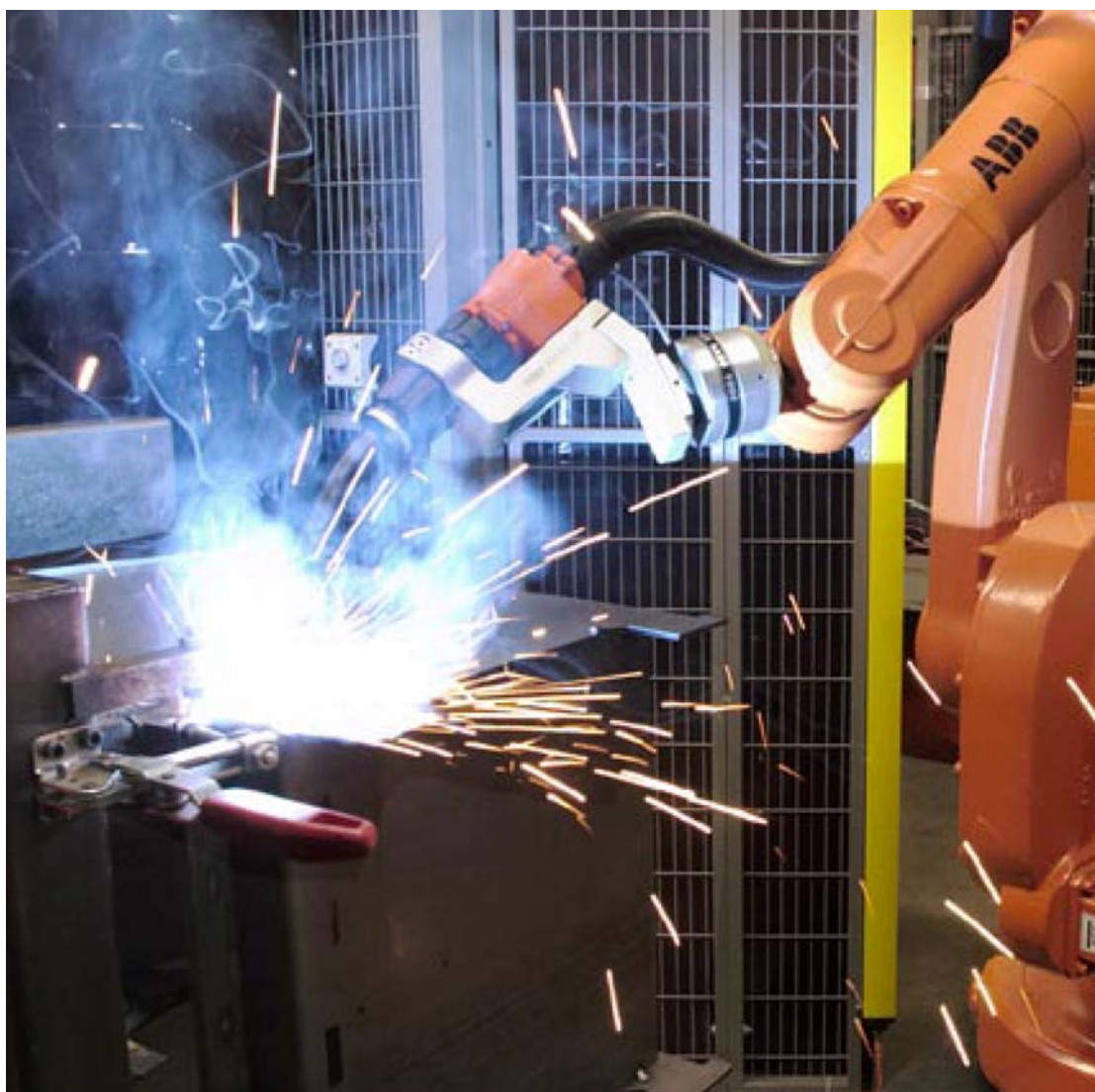
Εικόνα 26 Ρομπότ σε εφαρμογή ηλεκτροσυγκόλλησης
