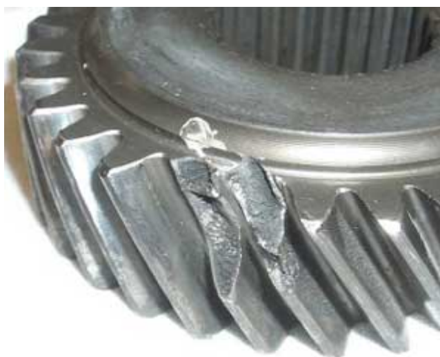
Εικόνα 46 Αστοχία λόγω ανεπαρκούς αντοχής στην κάμψη
