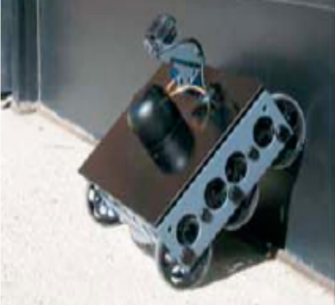
Εικόνα 3—2. Οι 6 ρόδες, και η ελκτική κίνηση του επιτρέπει να μεταβαίνει από το έδαφος στον τοίχο.
