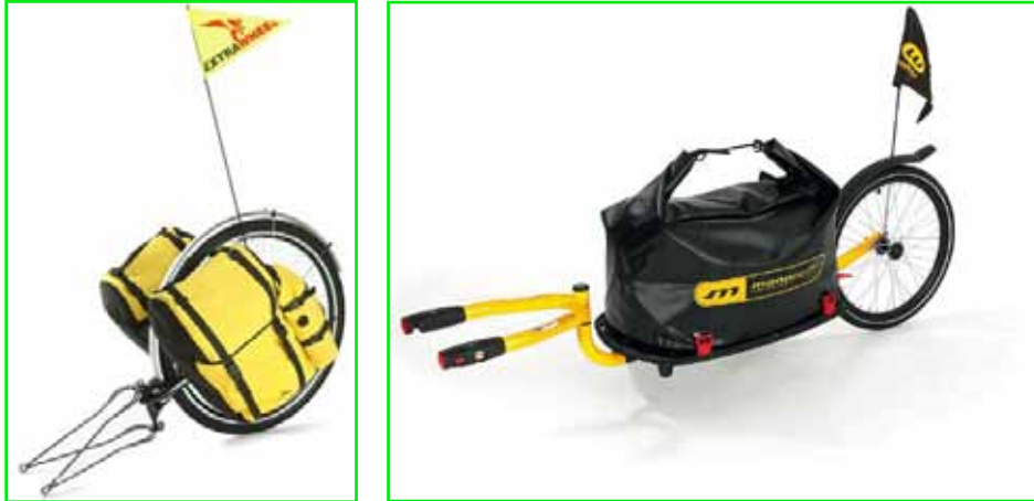
Εικόνα 124 και 125. Μονόροδα ρυμουλκούμενα
