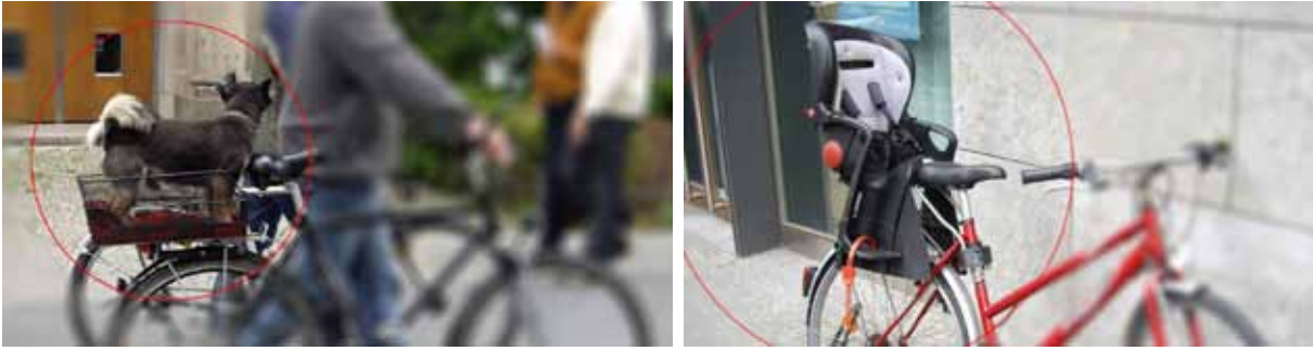
Εικόνα 119 και 120. Καλάθι και παιδικό κάθισμα που εμποδίζουν τη σύνδεση άλλου αποθηκευτικού μέσου με τον λαιμό της σέλας
