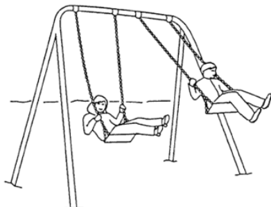
Σχήμα 6.3: Παράδειγμα κούνιας με έναν άξονα περιστροφής (Τύπος 1)
